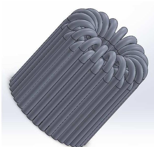
Figura 3.7. Scambiatore Elrond modellato con Solidworks®
