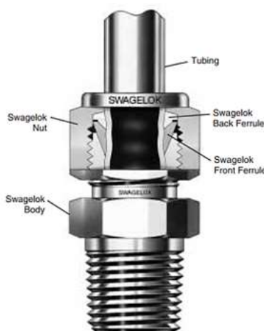
Figura 75: dettaglio Fitting utilizzato
