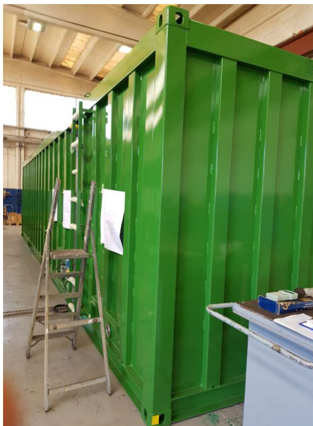
Figura 42: dettaglio rinforzi pareti perimetrali del serbatoio
