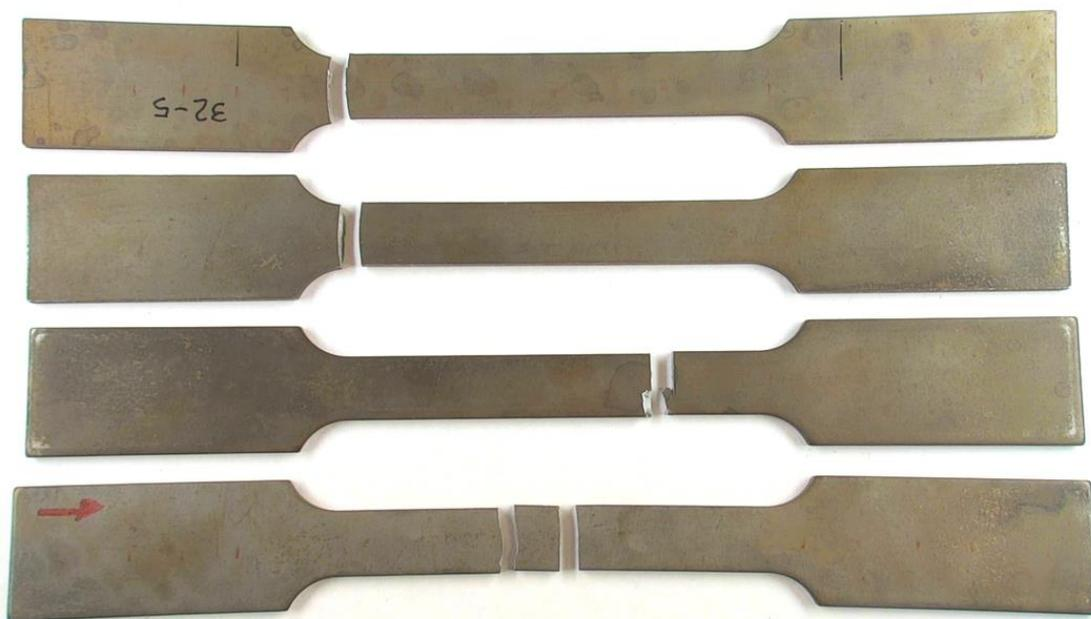
*figura 24 - Provini in 16MnCr5 con spessore 2,5 mm, carbonitrurati con profondità alta, dopo la prova di trazione*
