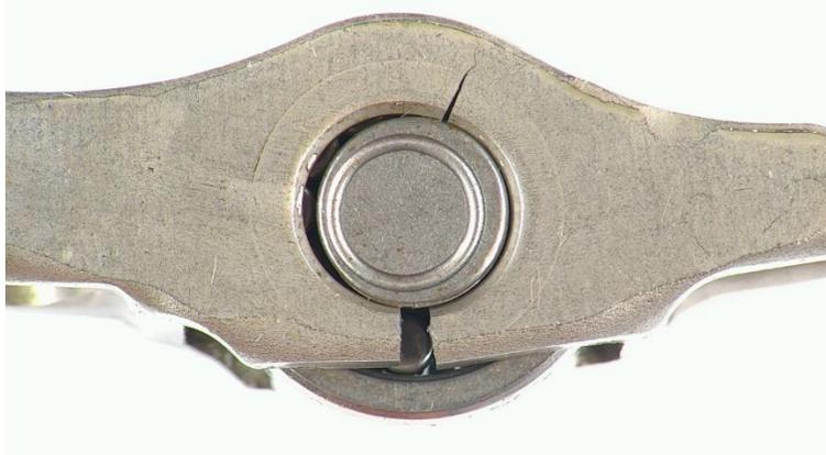
figura 85 – Rottura tipica del bilanciere 3
