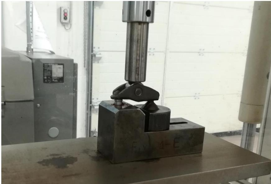
figura 67 – Prova di rigidezza su un bilanciere tipo 2
