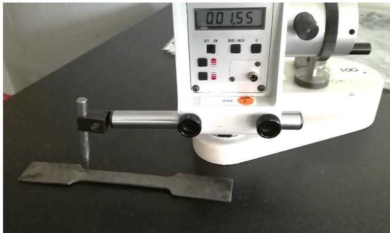
figura 19 - Misurazione del profilo di un provino con altimetro su un piano di riscontro
