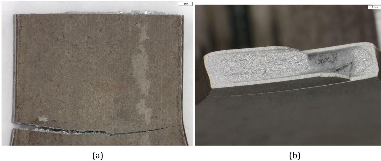
figura 29 - (a) frattura in un provino con case depth elevato, piana e perpendicolare all'asse di trazione; (b) frattura di un provino con case depth medio e spessore 2,75 mm, che presenta caratteristiche intermedie rispetto a quelle dei provini con carbonitrurazione superficiale e profonda.
