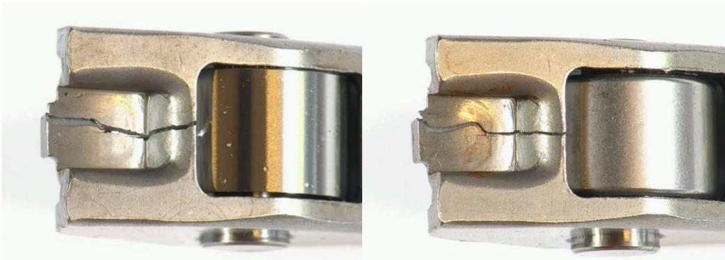
figura 83 – Rotture tipiche del bilanciante 2
