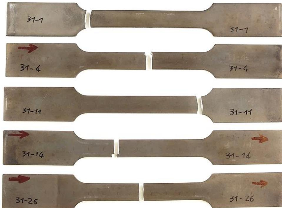
figura 48 - Frattura di alcuni provini dopo prova di fatica
