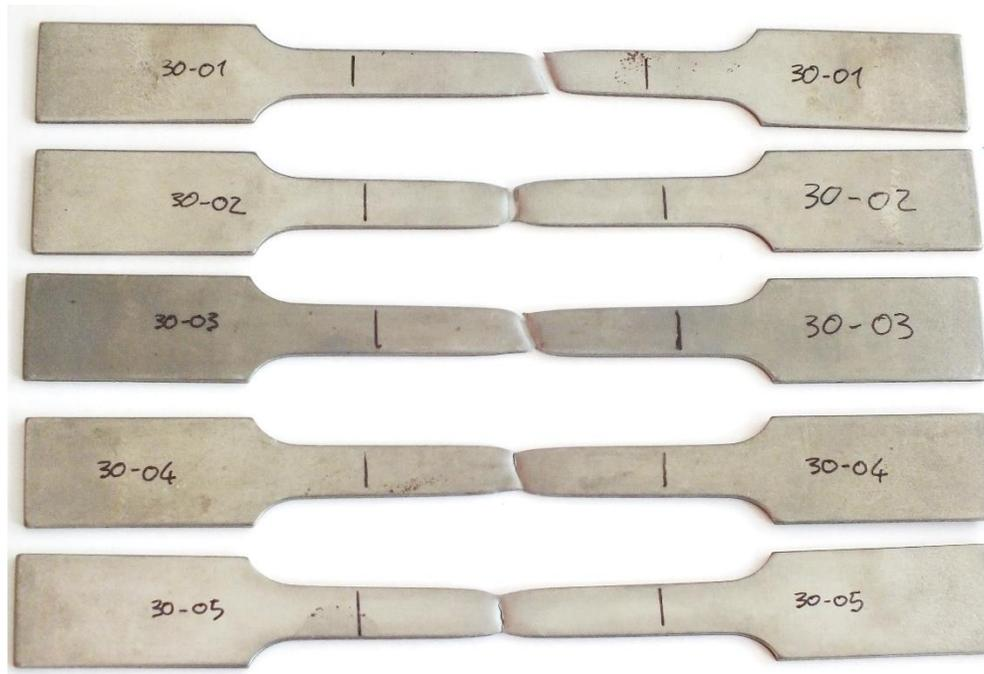
*figura 22 - Provini in 16MnCr5 con spessore 2,5 mm, non carbonitrurati, dopo la prova di trazione.*
