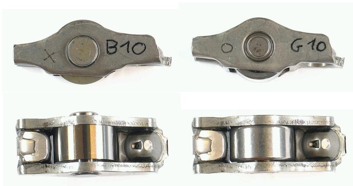
figura 79 – Due body di bilanciere assemblati con diverse modalità: a sinistra trattamento con case depth basso e assemblaggio con asse flottante e rullo pieno; a destra trattamento con case depth alto e assemblaggio con asse fisso e cuscinetto ad aghini
