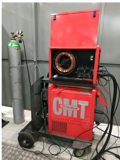
Figura 37: Transpuls Synergic 4000 CMT della Fronius
