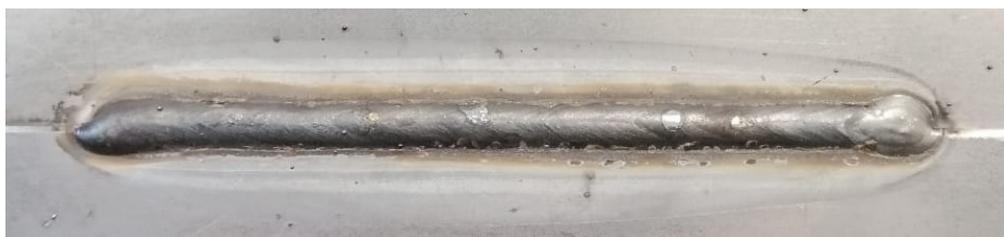
Figura 77: Provino realizzato a 400 mm/s
