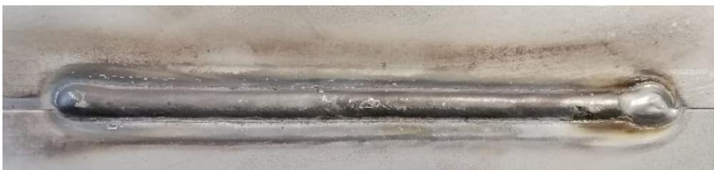
Figura 75: Provino esente da difetti realizzato a 440 mm/s
