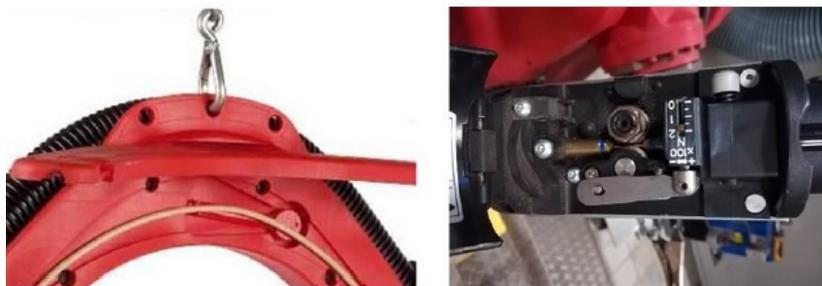
Figura 7: Wire buffer e motore integrato nella torcia
