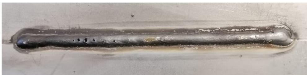
Figura 76: Provino realizzato a 540 mm/s
