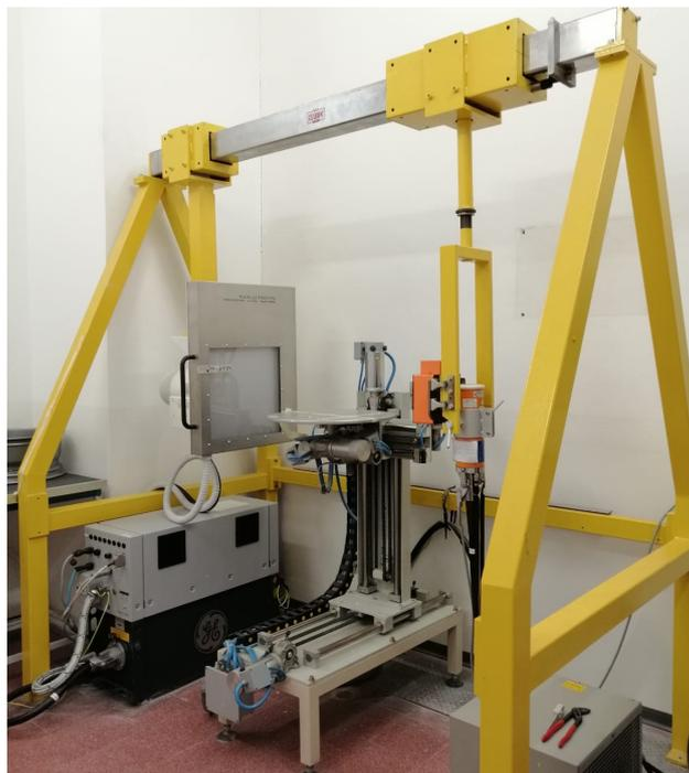
Figura 41: Sistema radioscopico
