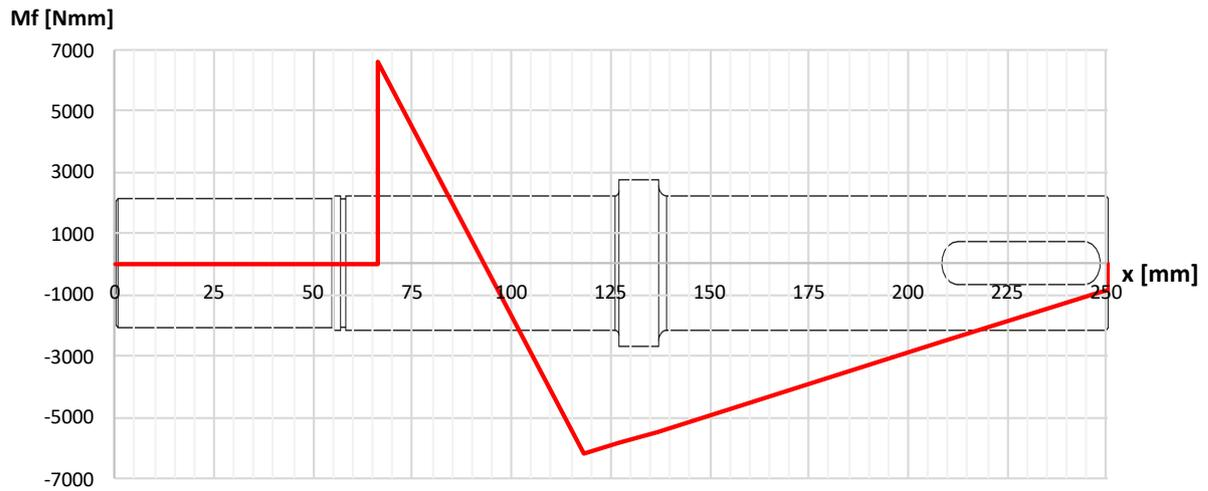
**Figura 3.34** – Diagramma di momento flettente albero lato motore
