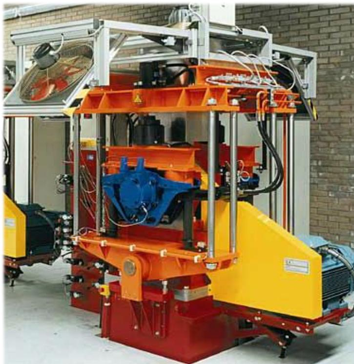
**Figura 1.10** – Banco prova boccole SKF [11]
