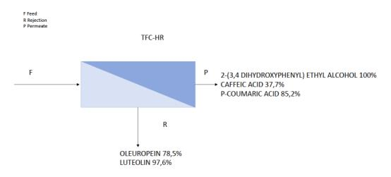
Figura 13 - Schema TFC-HR (F, feed: alimentazione, R, rejection: ritenzione, P, permeate: permeato)
