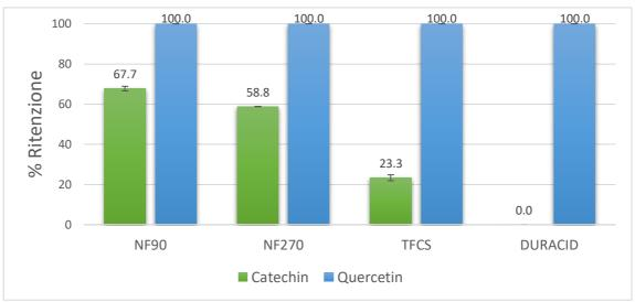
Figura 10 - Risultati della nanofiltrazione per la catechina e la quercetina
