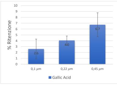
Figura 9 - Analisi dei risultati di microfiltrazione per l'acido gallico
