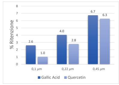
Figura 8 - Risultati della microfiltrazione per l'acido gallico e la quercetina
