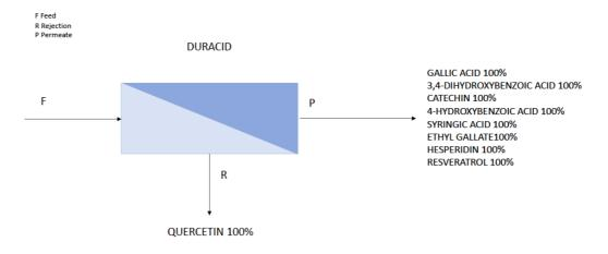
Figura 11 - Schema DURACID (F, feed: alimentazione, R, rejection:ritenzione, P, permeate: permeato)
