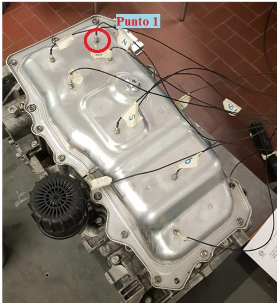
Figura 44 - Set-up della prova con il primo set di accelerometri.
