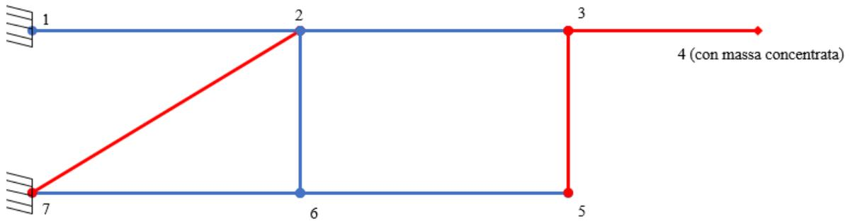
Figura 14 - Struttura esempio. In azzurro le travi, in rosso gli elementi rigidi, i nodi 1 e 7 sono incastrati, in 4 c'è una massa concentrata.
