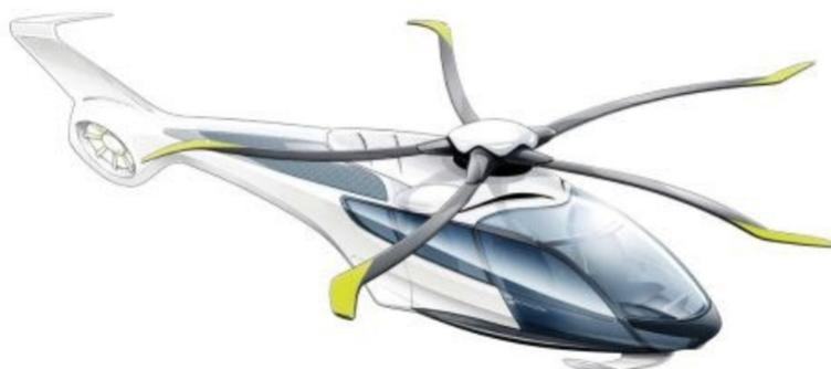
**Figura 1.4:** Sketch del X4 della airbus helicopter (ora H160) in cui si nota l'utilizzo delle pale *Blue edge* [1]
