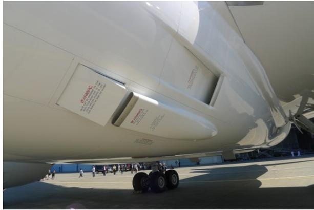
Figura 2.21: Presa d'aria del compressore dedicato per il sistema ECS del Boeing 787
