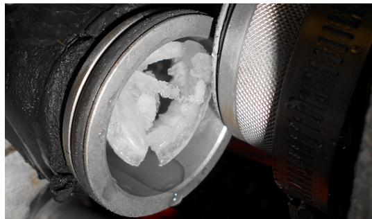
Figura 2.28: Formazione di ghiaccio in uscita dalla turbina
