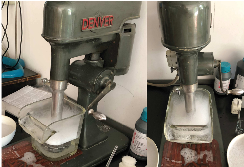
Figura 5.9 Foto della cella di flottazione Denver utilizzata per il procedimento di separazione del materiale fine.
