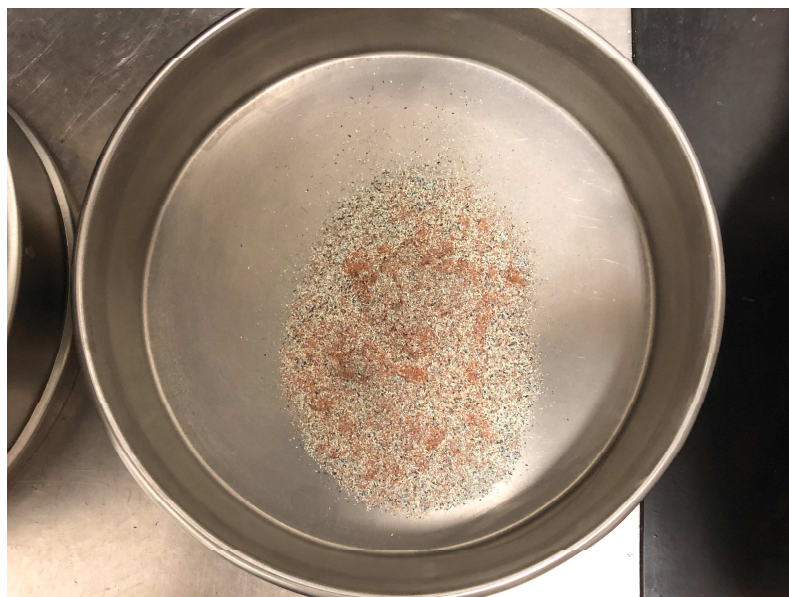
Figura 5.7 Foto del materiale fine (<0,5 mm) dopo la setacciatura realizzata a valle della tritrazione.
