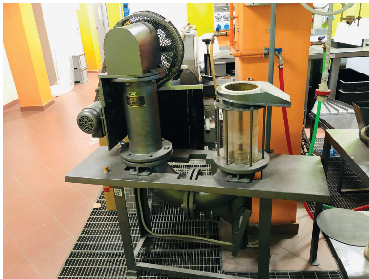
Figura 5.19 Foto del crivello idraulico utilizzato per gli esperimenti sul materiale grossolano (>0,5 mm).
