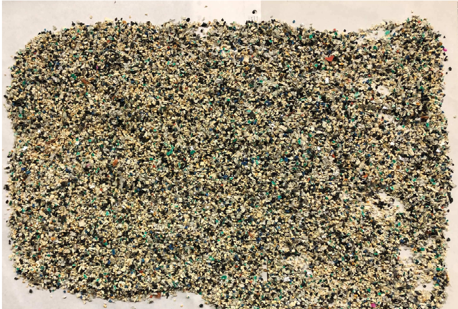
Figura 5.24 Foto del materiale non conduttivo riunito (NC1+NC2+NC3+NC4) ottenuto dalla separazione elettrostatica del materiale grossolano (>0,5 mm).
