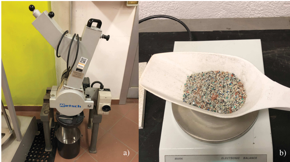
Figura 5.6 a) Foto del tritatore usato per riduzione volumetrica e b) materiale in output alla tritrazione.
