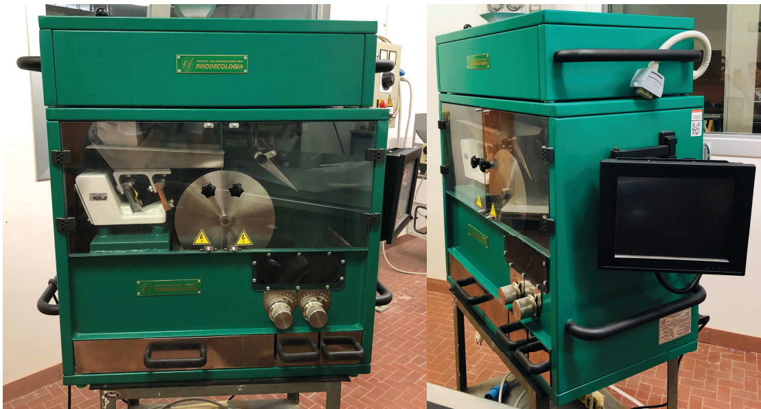
Figura 5.21 Foto del separatore elettrostatico utilizzato per le sperimentazioni sul materiale grossolano (>0,5 mm).
