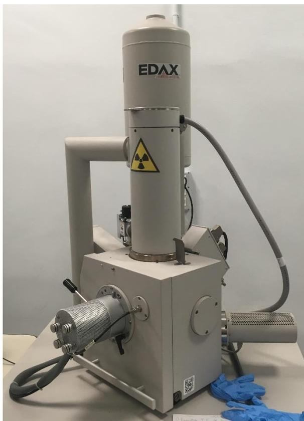
Figura 39- Microscopio Elettronico a Scansione (SEM) FEI mod. QUANTA INSPECT 200 LV
