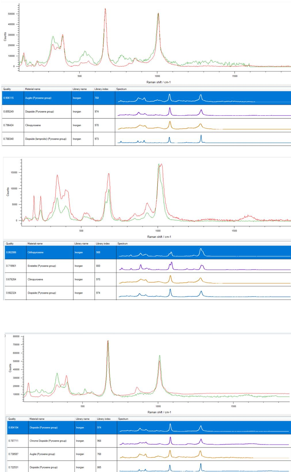
Figura 59- Spettri ricavati dalle analisi con il micro-Raman che mostrano risultati differenti ma sempre legati alla famiglia delle olivine o altri silicati
