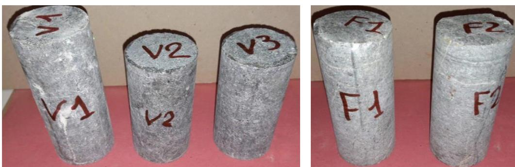
Figura 46- Provini cilindrici ottenuti da carotaggio in laboratorio su blocchetti di roccia prelevati dall'abbattuto
