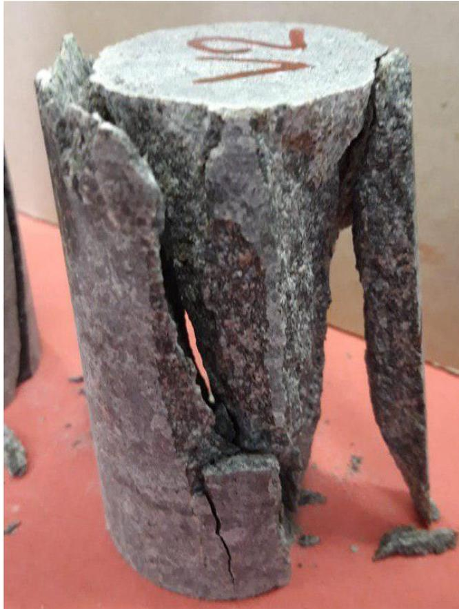
Figura 48- Provino V2 con accenno di conetto di rottura alla Mohr-Coulomb
