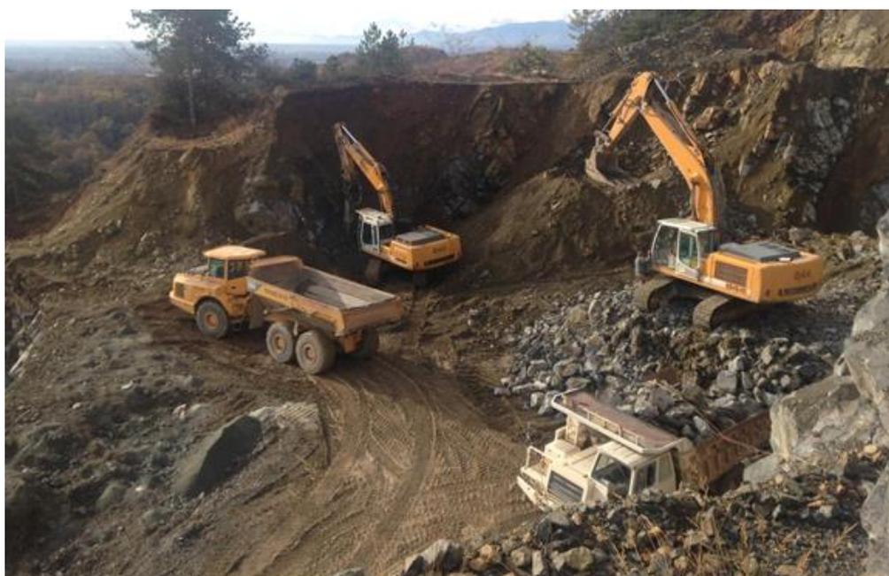
*Figura 28- Fase di riduzione pezzatura con martelloni e carico su dumper*
