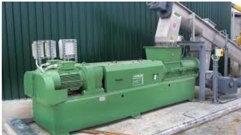
Figura 2.4: Estrusore utilizzato come pretrattamento nella digestione anaerobica.
