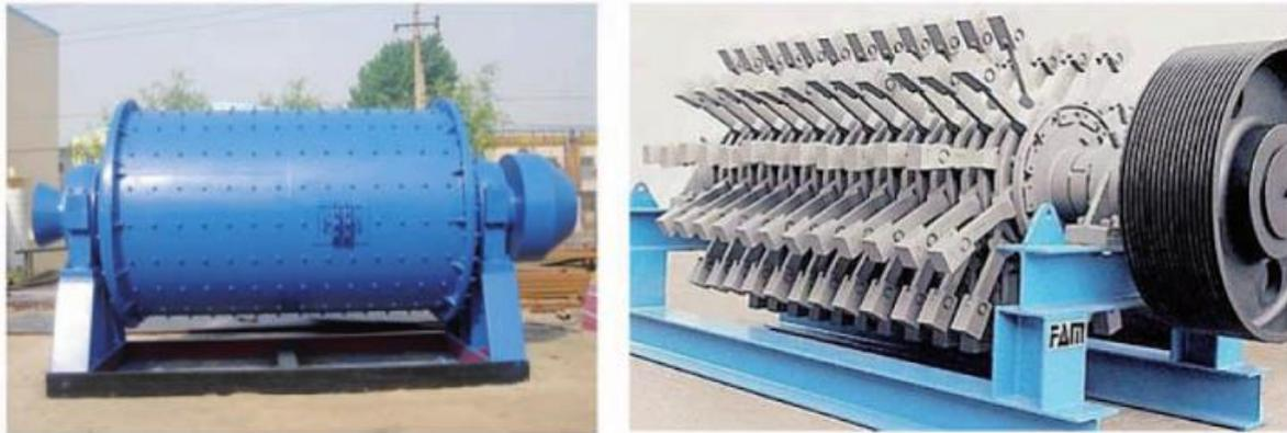
Figura 2.3: Dispositivi per la molitura, mulino a palle e mulino a martelli (Castelli,2011).
