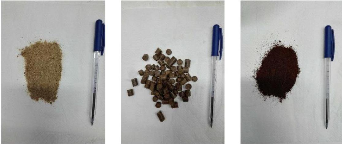
Figura 3.9: Sottoprodotti dello stabilimento B. Da sinistra a destra: scarto crudo; pellet; scarto tostato<sup>85</sup>.
