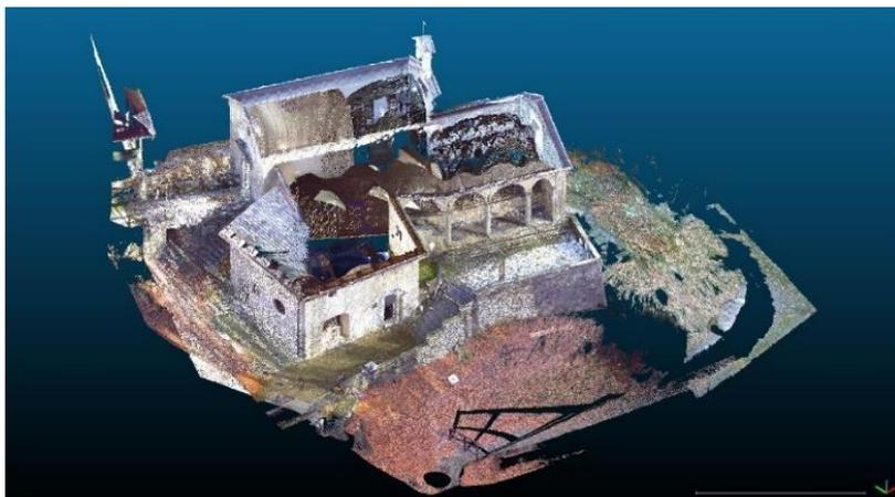
Figura 133 - *File* generato dall'unione delle nuvole derivanti dall'acquisizione tramite *laser scanner*.
