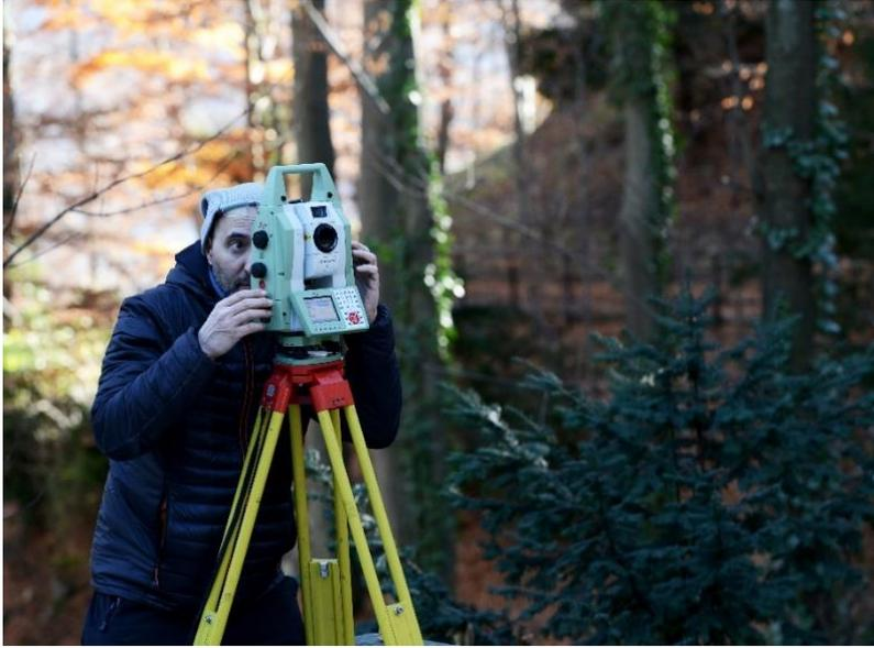
Figura 55 - Fase di collimazione ottica tra stazione totale e prisma.
