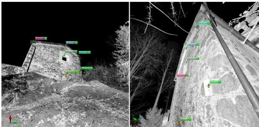
Figura 82 - Esempio di identificazione dei punti notevoli tra le scansioni Frana\_20\_10036 e Frana\_20\_10037, nelle quali non è stato possibile usare la sola l'individuazione dei *marker*.
