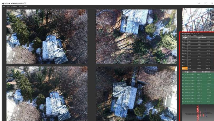
Figura 111 - Screenshot della procedura di collimazione manuale del comando Sai-sieAppuisnit effettuata correttamente.
