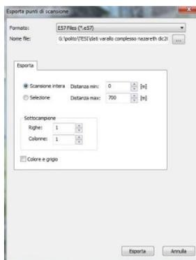
Figura 97 - Impostazioni adottate per l'esportazione delle singole nuvole in formato .E57.
