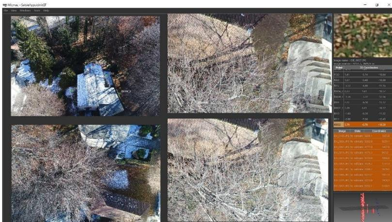
Figura 110 - Interfaccia grafica del comando *SaisieAppuisInit* attraverso il quale eseguire la validazione dei *marker* a terra.
