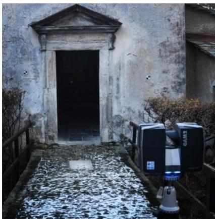
Figura 51 - Laser scanner Faro CAM 2 Focus 3D in fase di rilievo.
