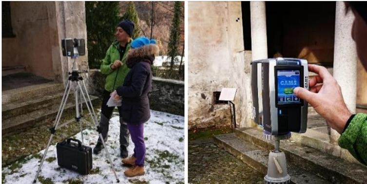
Figura 62 – Gli operatori Paolo Maschio e Francesca Matrone eseguono la procedura di messa in stazione del *laser scanner*, e settaggio delle impostazioni di acquisizione per la prima scansione. Foto: A. Ursini.
