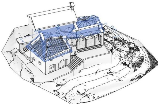
Figura 198 - Importazione della superficie di copertura.
