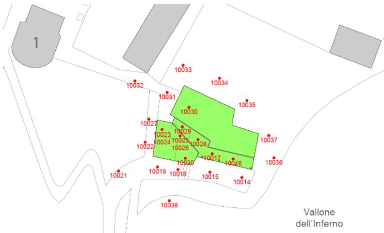
Figura 63 - Schema dei punti di acquisizione delle scansioni laser.
