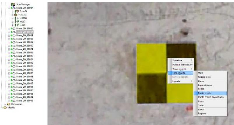
Figura 78 - Procedura manuale per l'individuazione del punto medio del target.
