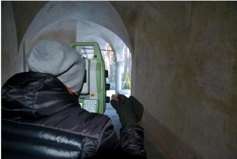
Figura 56 - Fase di collimazione tra la stazione totale sul vertice 24400 e prisma piatto in stazionamento sul treppiede posizionato sul vertice 24200 (sullo sfondo).
