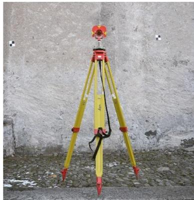
Figura 50 - Prisma GPR111 su treppiede (a destra) e prisma 360° su palina regolabile (a sinistra). Foto: A. Ursini.
