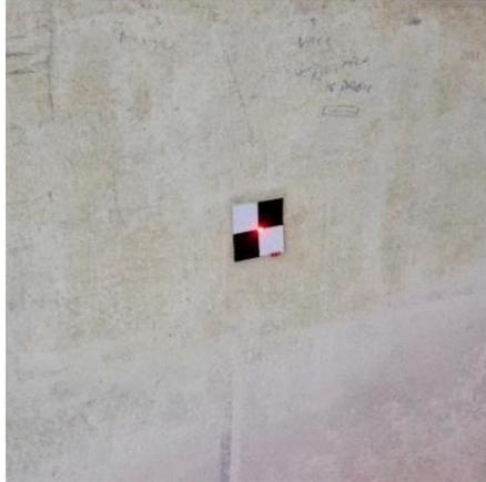
Figura 60 - In questa immagine è possibile notare la traccia lasciata dall'impulso laser emessa dalla stazione totale durante la fase di acquisizione delle coordinate del centro di uno dei *marker* interni alla struttura. Foto: A. Ursini.
