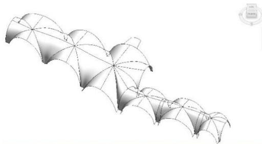
Figura 186 - Massa generata attraverso l'importazione di superfici modellate in ambiente CAD.
