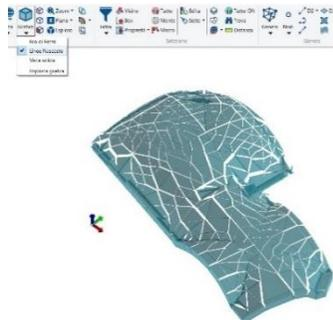
Figura 228- Visualizzazione della volta della cappella 4 con grafica in modalità *Linea Nascosta*.
