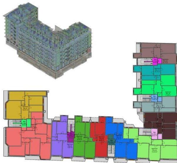
Fig. 31: Numero locali del piano tipo ed analogo modello energetico tridimensionale relativo allo step 2.
