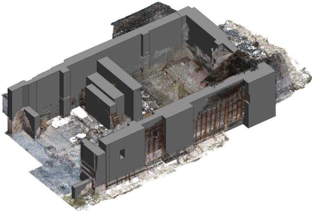
*Fig. 89 – Vista 3D con modellazione dei muri sulla nuvola di punti.*
