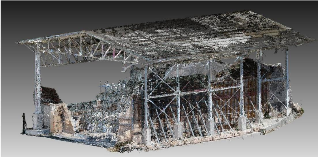
*Fig. 66 – Nuvola fotogrammetrica pulita.*
