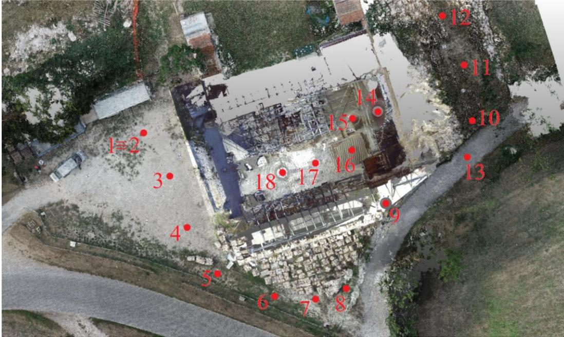
Fig. 50 – Schema di posizionamento delle diciotto scansioni laser scanner.
