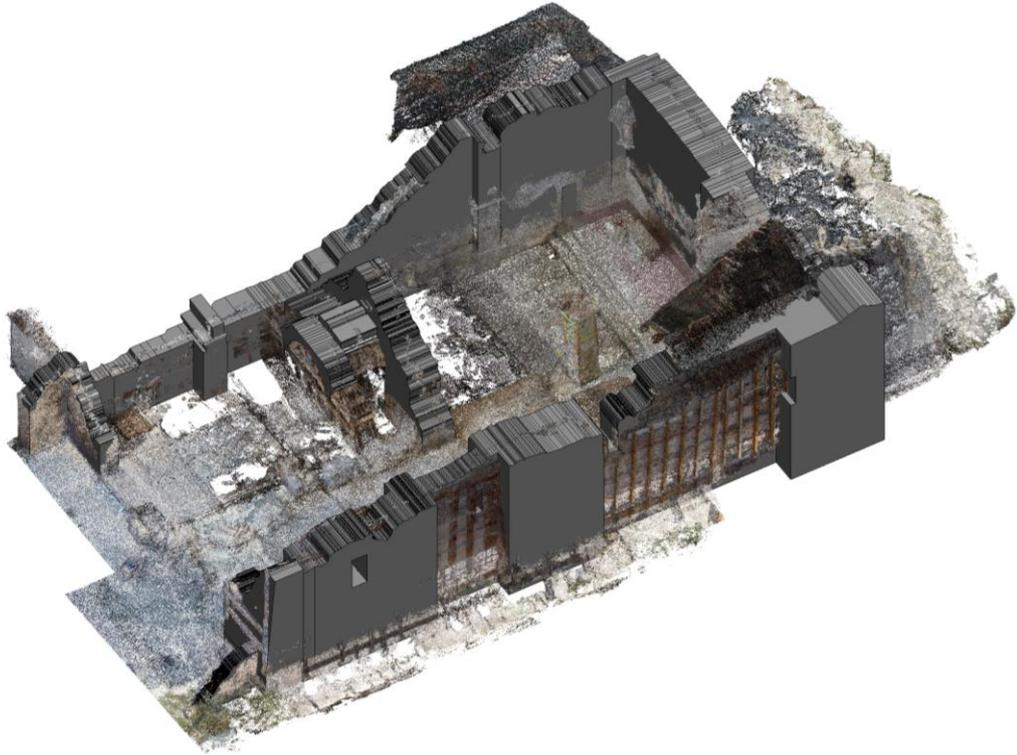
*Fig. 91 – Vista 3D con muri modellati secondo l'andamento dei crolli.*
