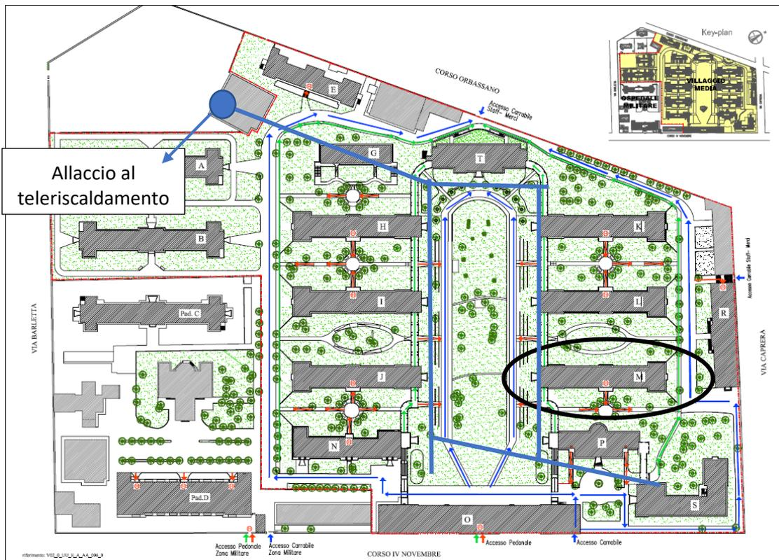
Figura 12 , Planimetria Caserma Riberi , Padiglione M , schema rete del Teleriscaldamento
