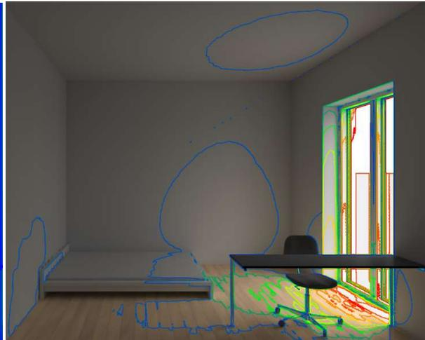
*CAMERA SINGOLA: Visualizzazione 3D della distribuzione del FLDm con rilevazione a linee ISO.*
