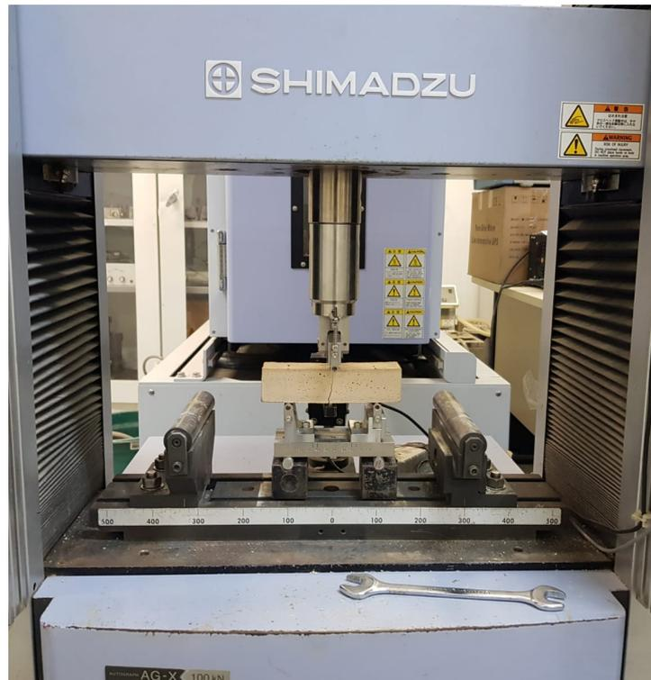
**Figura 4. 21 – Prova di flessione.**
