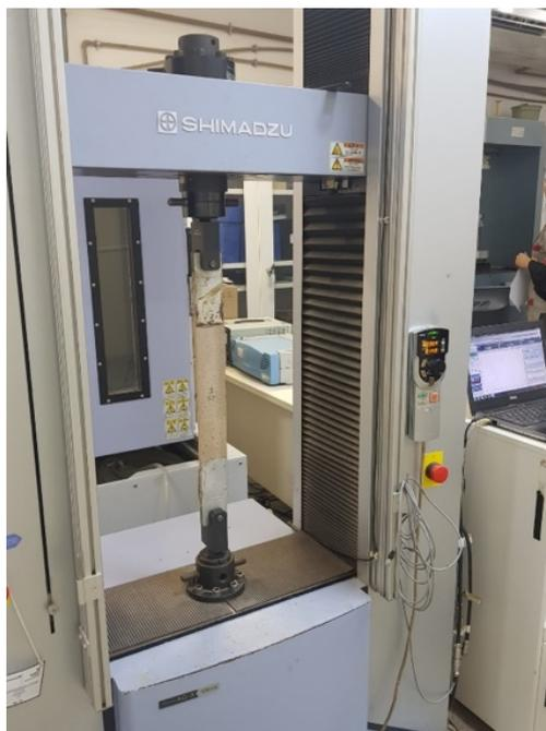
**Figura 4. 77 – Setup del test di trazione diretta della placca di composito rinforzato con fibra naturale.**
