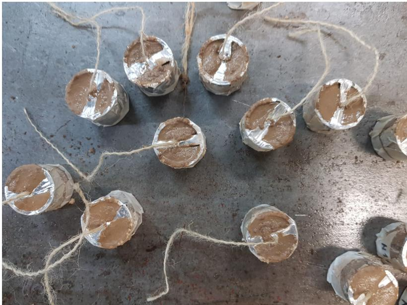
**Figura 4. 70 – Inserimento della malta nei cilindri (alto).**
