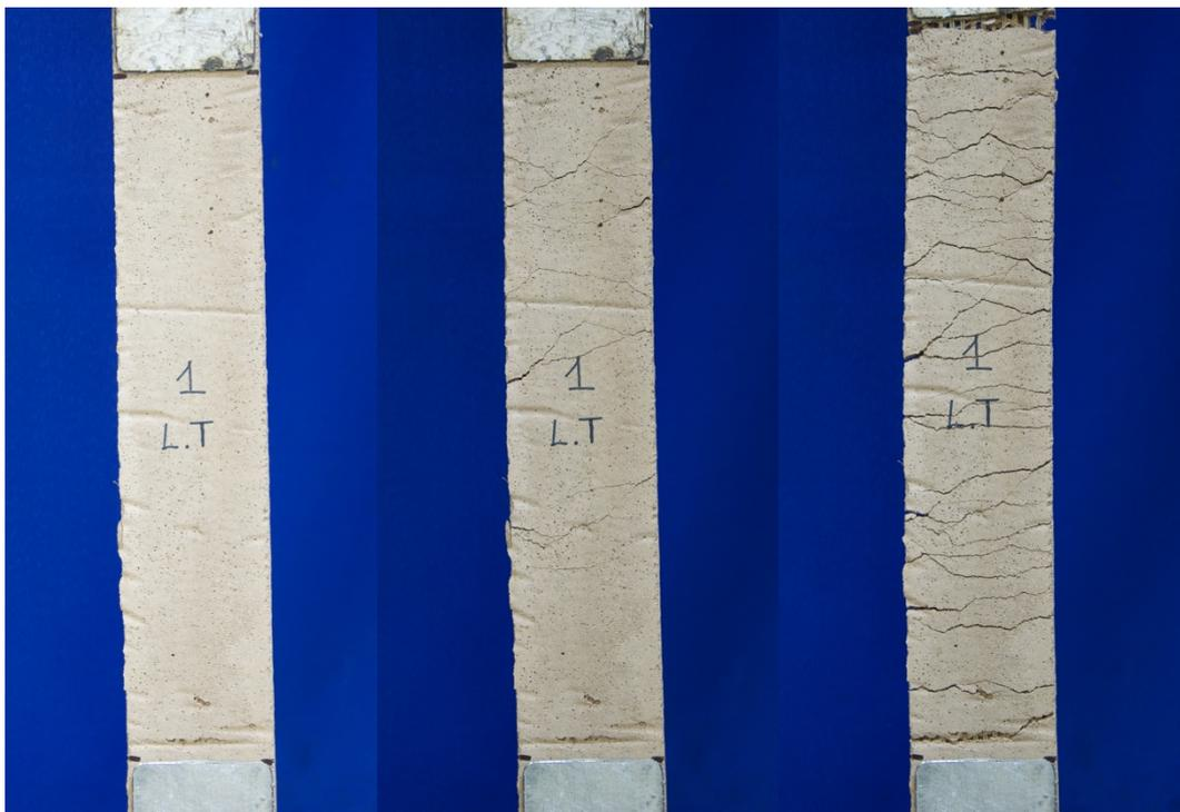
**Figura 4. 101 – Test di trazione diretta della placca di composito di matrice a base cementizia rinforzata con doppio strato di tessuto di fibra di lino trattato con soluzione alcalina.**
