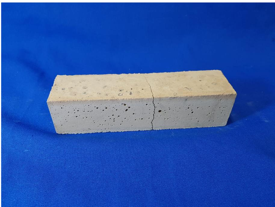
**Figura 4. 23 – Corpo di prova sottoposto al test di flessione a 28 giorni di maturazione.**
