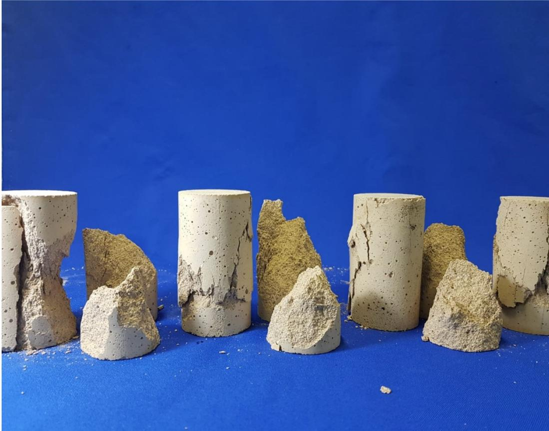
**Figura 4. 14 – 7 cilindri sottoposti al test di compressione a 28 giorni di maturazione.**
