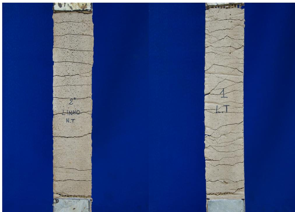
**Figura 4. 104 – Immagine relativa al confronto tra i corpi di prova del composito rinforzato con fibra di lino non trattata e trattata dopo essere stati sottoposti a test di trazione diretta.**
