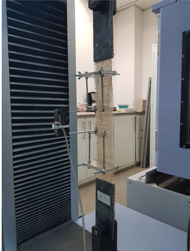
**Figura 4. 53 – Test di trazione del tessuto di iuta.**
