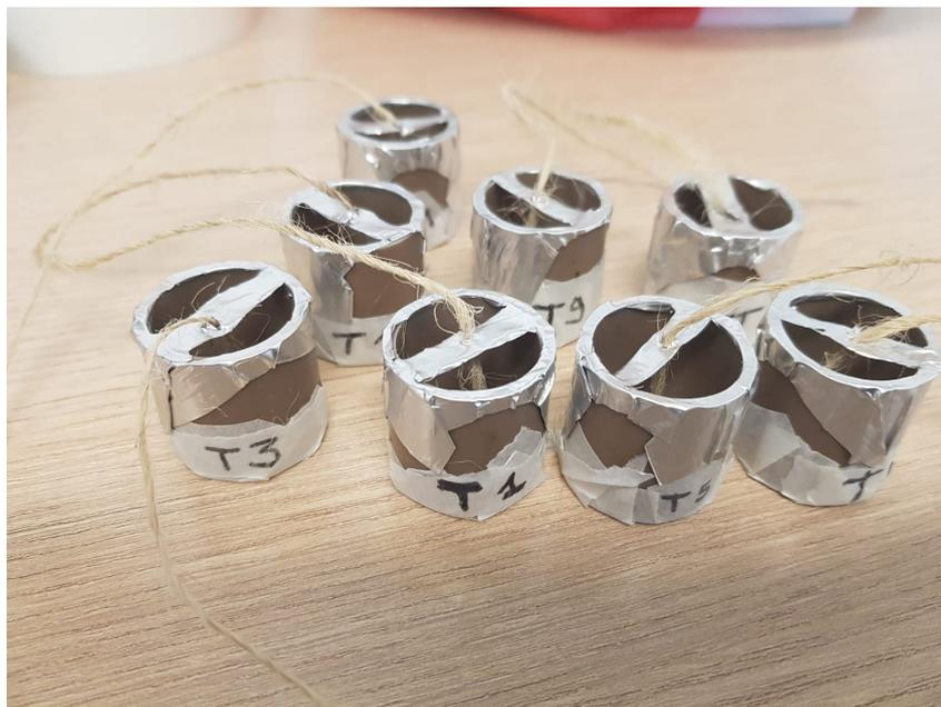
**Figura 4. 68 – Preparazione corpi di prova test Pull out.**
