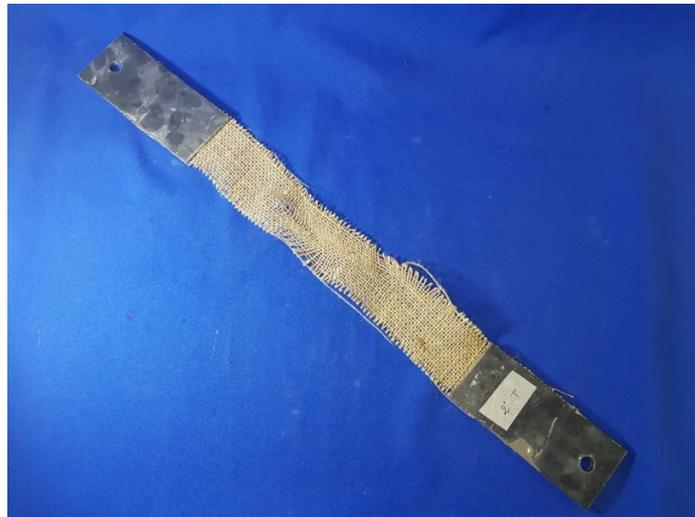
**Figura 4.56 – Corpo di prova del tessuto di iuta trattato sottoposto a trazione diretta.**
