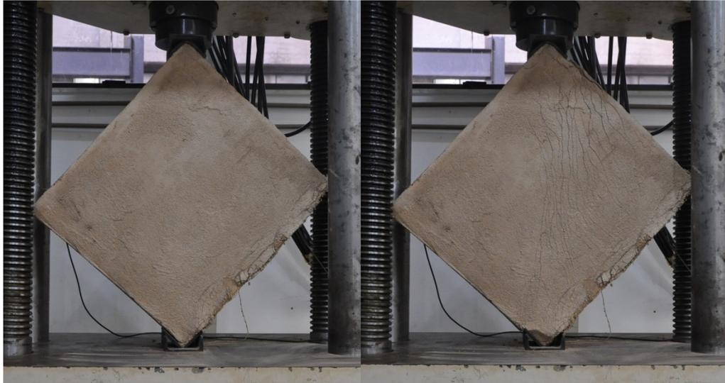
**Figura 4. 117 – Immagini relative alla prova di compressione diagonale della prima parete in muratura rinforzata con tessuto di iuta non trattato.**
