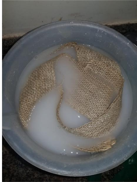
**Figura 4. 30 – Trattamento della fibra di iuta in soluzione alcalina.**
