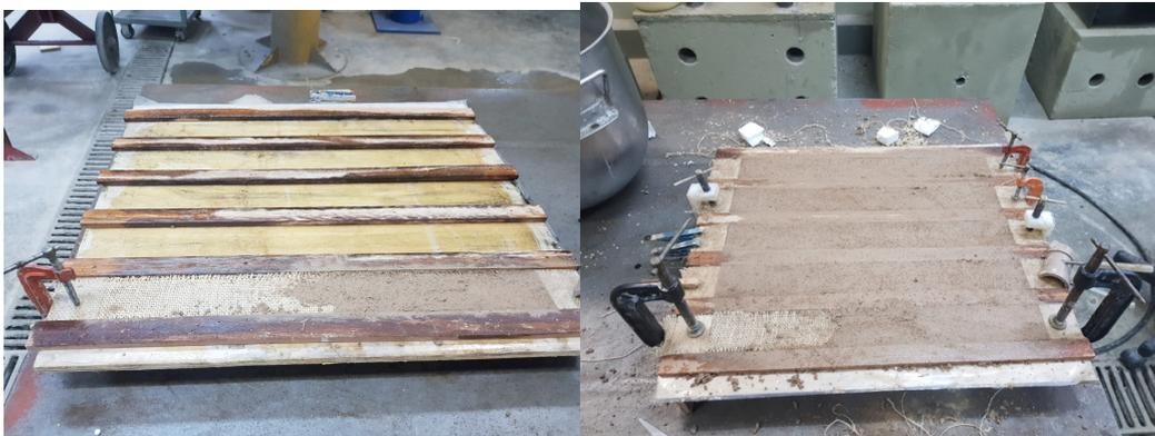
**Figura 4. 75 – Realizzazione dei provini di composito tessuto e matrice per il test di trazione diretta.**
