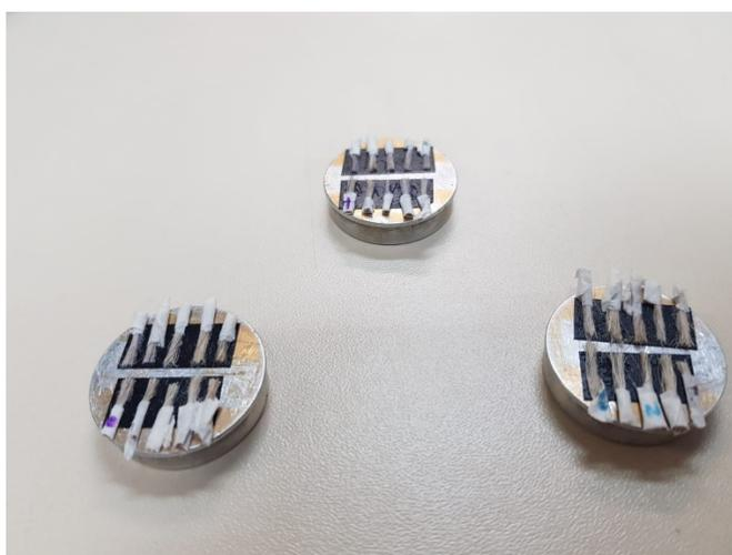
**Figura 4. 44 – Corpo di prova delle corde di iuta realizzati per il SEM.**
