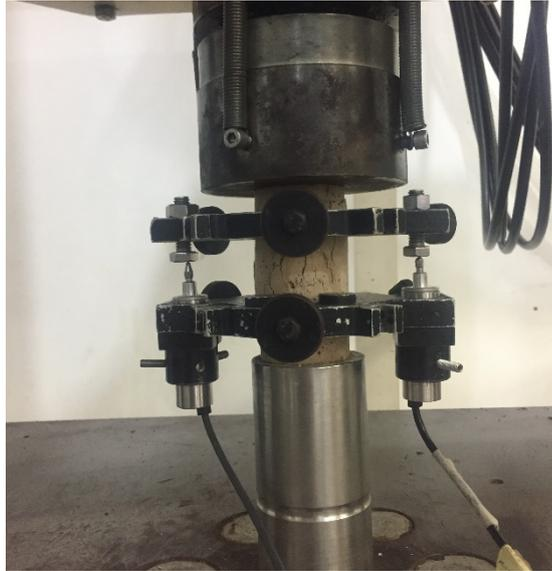
Figura 4. 11 – Provino sottoposto alla prova di compressione.
