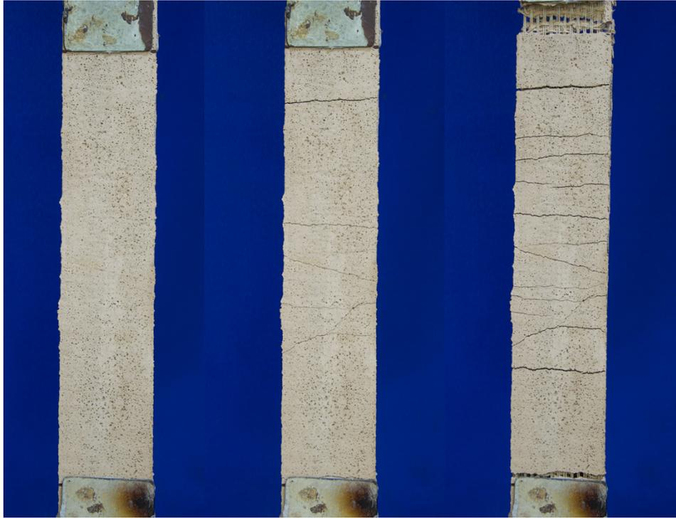
Figura 4. 96 – Test di trazione diretta del composito rinforzato con lino non trattato.
