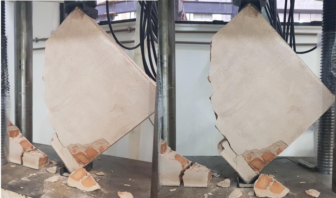
**Figura 4. 112 – Rottura fragile della parete priva di rinforzo in fibra.**
