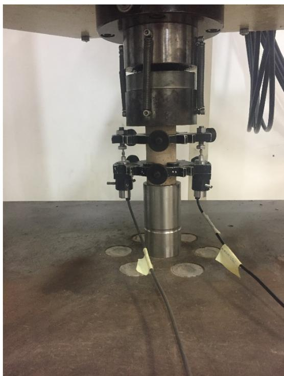
**Figura 4. 10 – Set up della prova di compressione della malta.**
