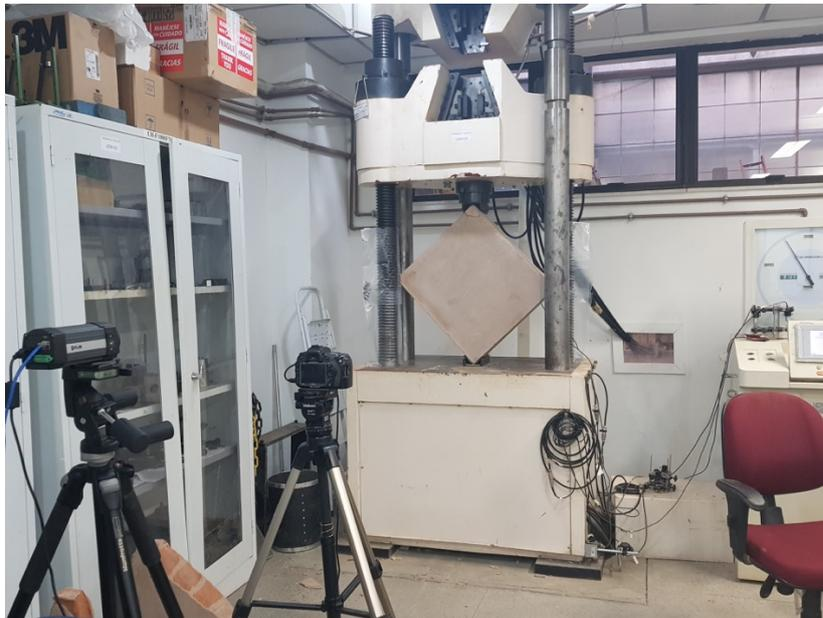
**Figura 4. 111 – Test di compressione diagonale della parete priva di rinforzo.**
