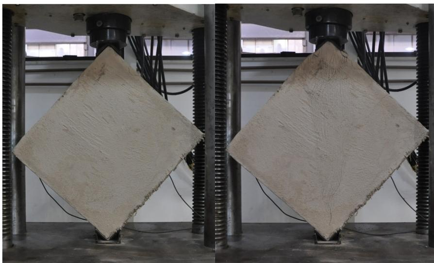
**Figura 4. 131 – Immagini relative alla prova di compressione diagonale della prima parete in muratura rinforzata con tessuto di lino trattato.**
