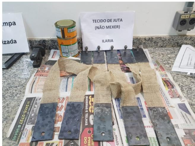
**Figura 4. 52 – Preparazione dei corpi di prova per il test di trazione diretta del tessuto di iuta trattato e non trattato**
