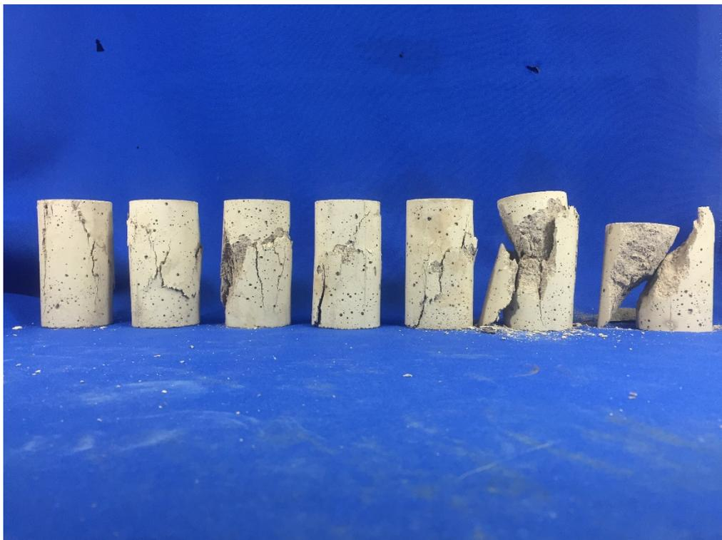
**Figura 4. 13 – 7 cilindri dopo il test di compressione a 14 giorni di maturazione.**
