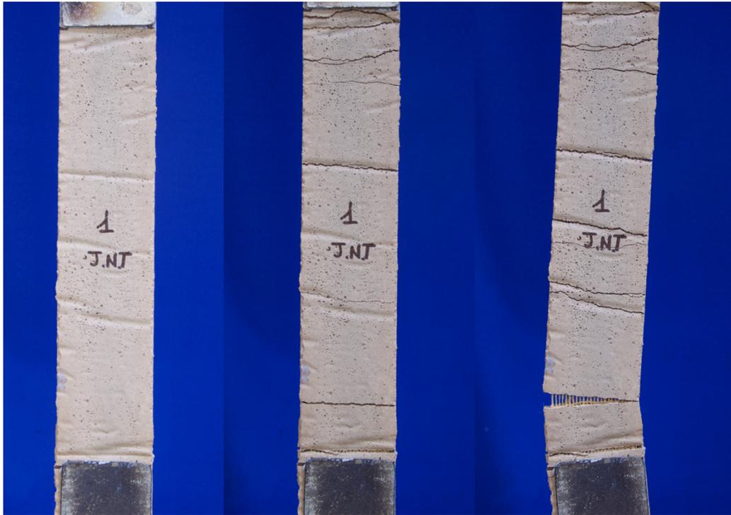
Figura 4. 83 - Test di trazione diretta della placca di composito rinforzata con due strati di tessuto di iuta non trattata.
