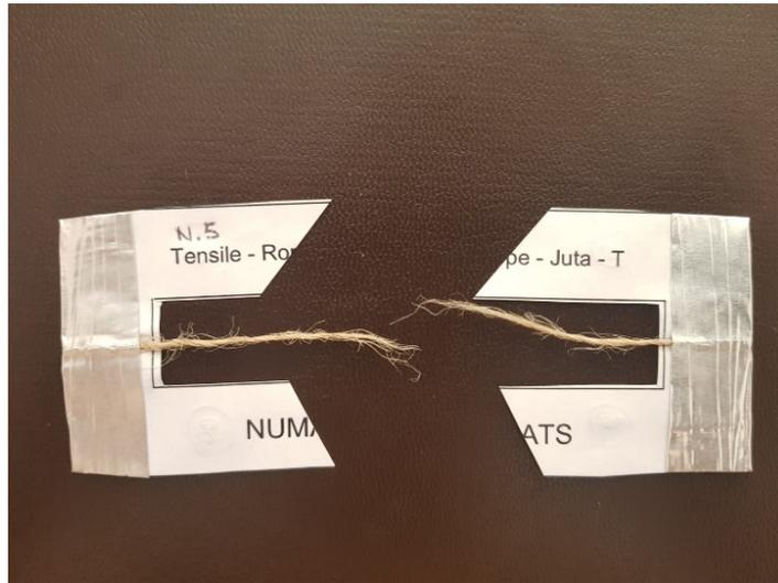
**Figura 4. 39 – Corpo di prova del test di trazione della corda di iuta trattata nella fase successiva alla prova.**
