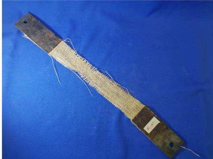
**Figura 4.55 – Corpo di prova del tessuto di iuta non trattato sottoposto a trazione diretta.**
