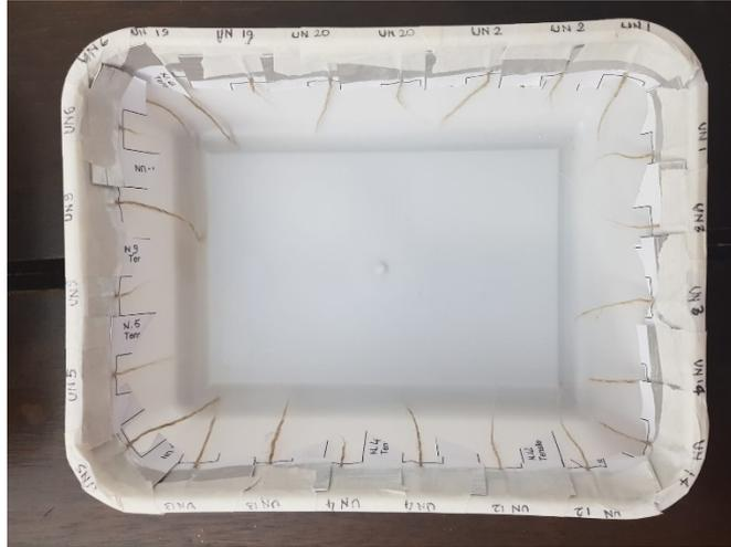
**Figura 4. 41 – Corpi di prova del test di trazione della corda di iuta durante il lavaggio in acqua.**
