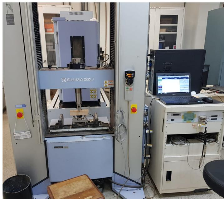
Figura 4. 20 – Macchina di prova per la flessione.
