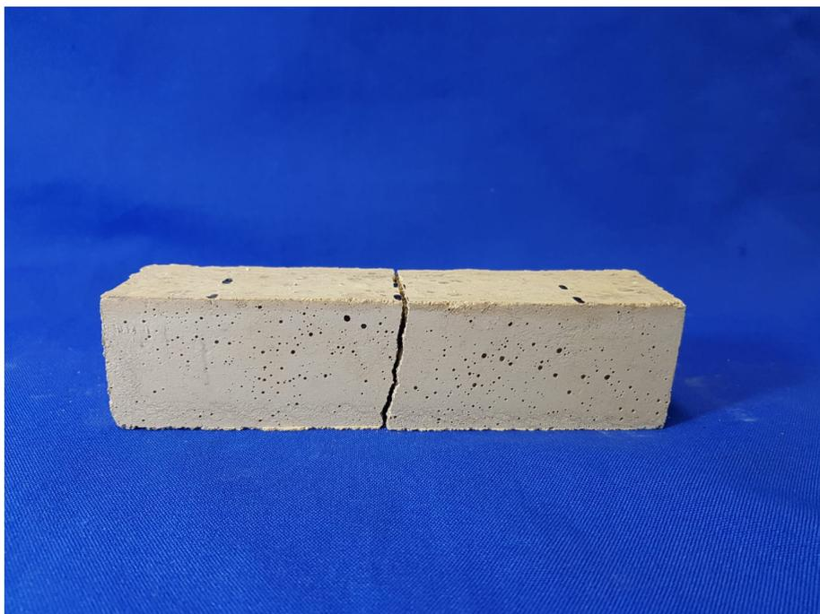
**Figura 4. 22 – Corpo di prova sottoposto al test di flessione a 14 giorni di maturazione.**
