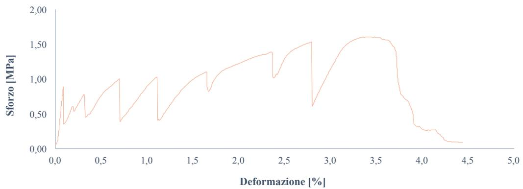
**Figura 4. 82 – Diagramma sforzo-deformazione del provino relativo al composito, rinforzato con tessuto in fibra di iuta non trattata, che risulta avere un comportamento più vicino a quello medio.**
