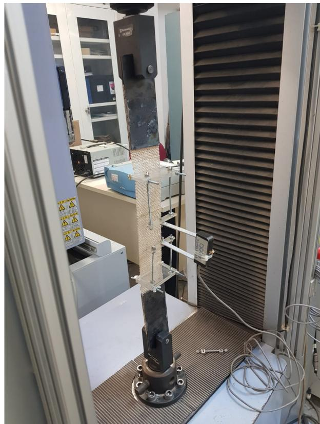
**Figura 4. 54 – Test di trazione del tessuto di iuta.**
