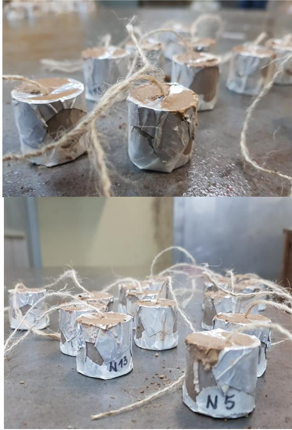
**Figura 4. 69 – Inserimento della malta nei cilindri.**
