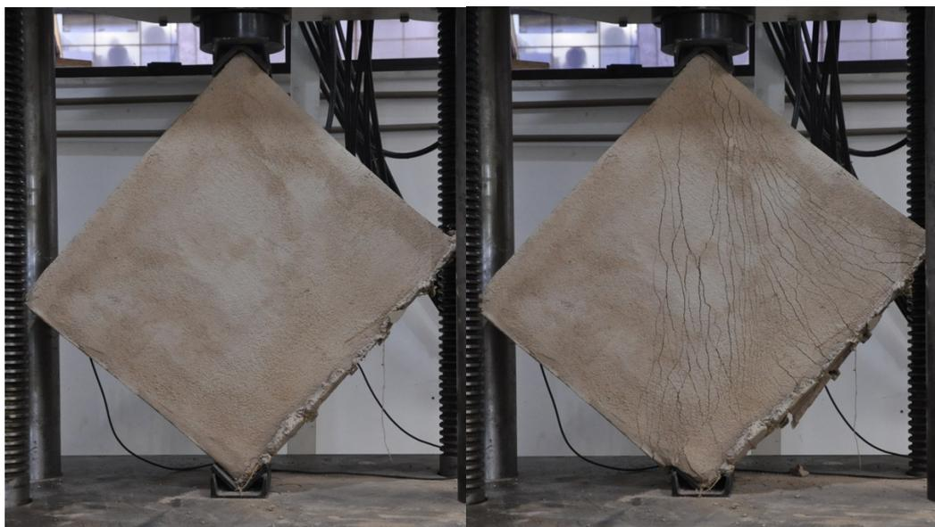
**Figura 4. 124 – Immagini relative alla prova di compressione diagonale della seconda parete in muratura rinforzata con tessuto di iuta non trattato.**
