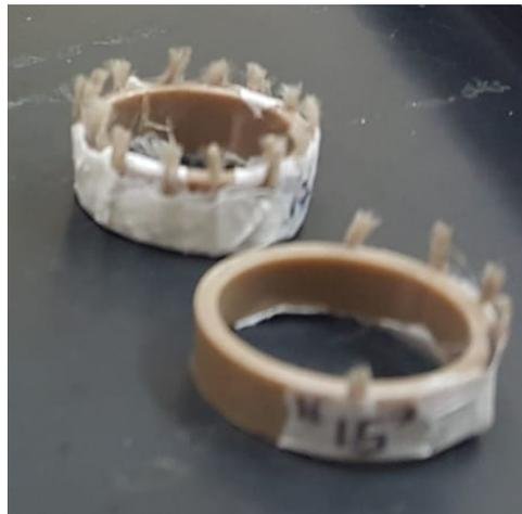
**Figura 4. 42 – Corpi di prova delle corde di iuta per la determinazione dell'area di sezione tramite il SEM.**
