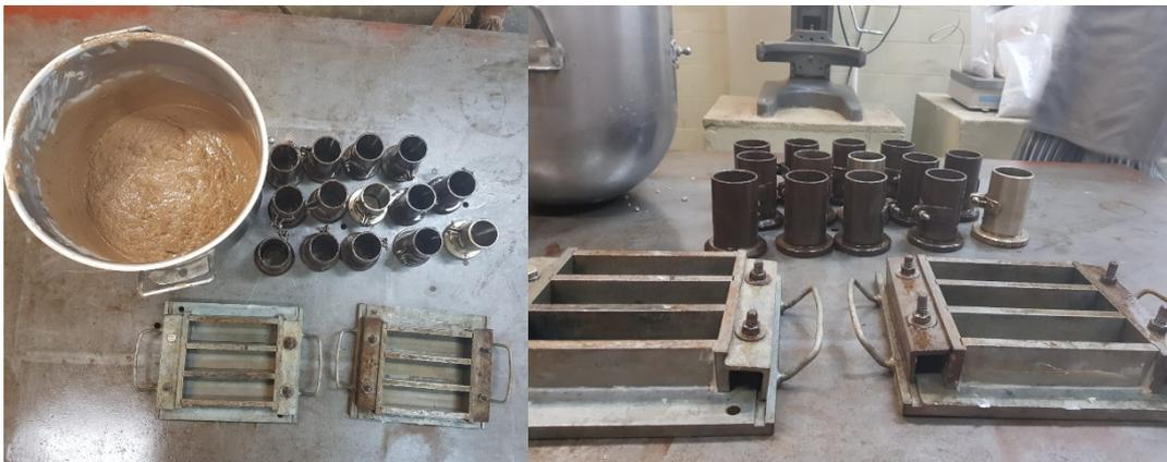
**Figura 4. 7 – Riempimento dei corpi di prova.**
