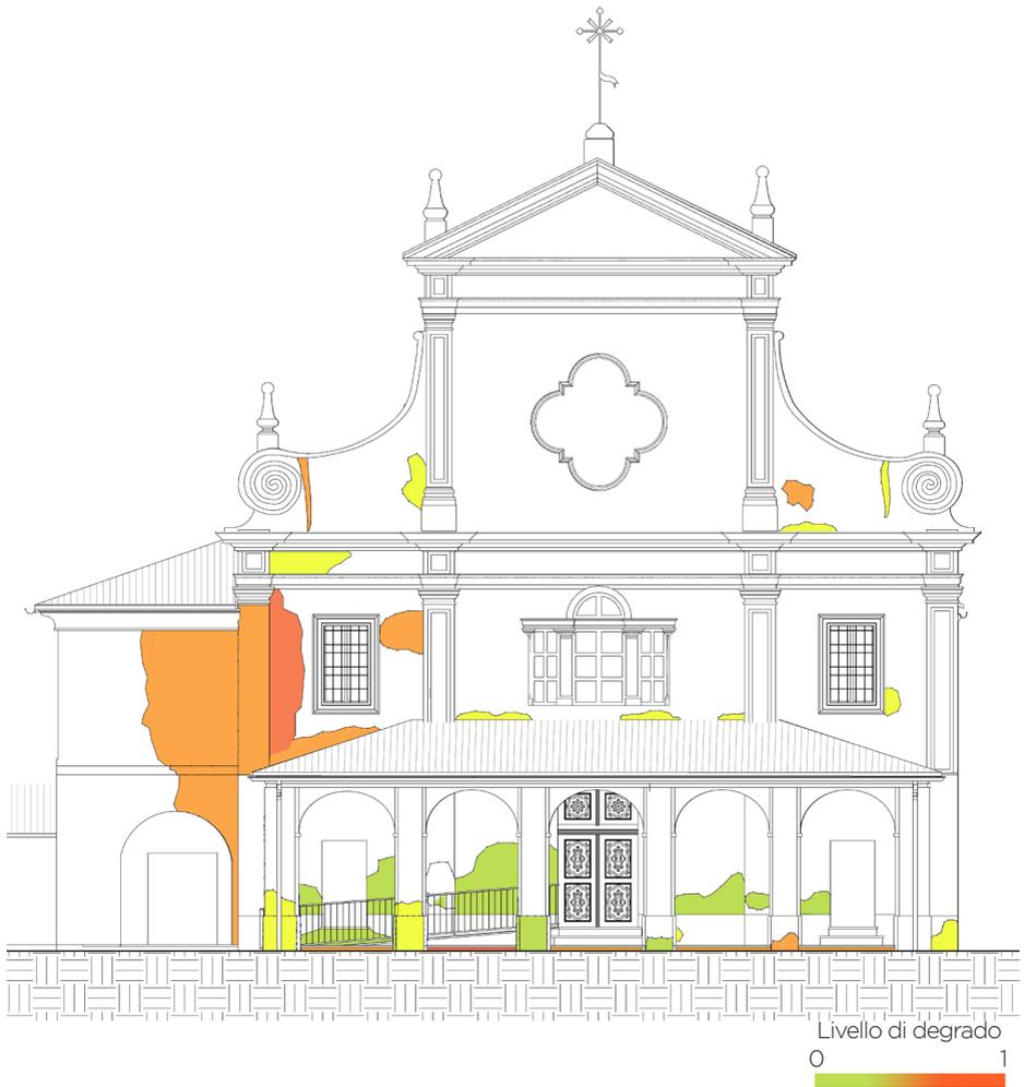
Fig 68 - Screenshot dell'esecuzione dello script per la colorazione dei degradi
