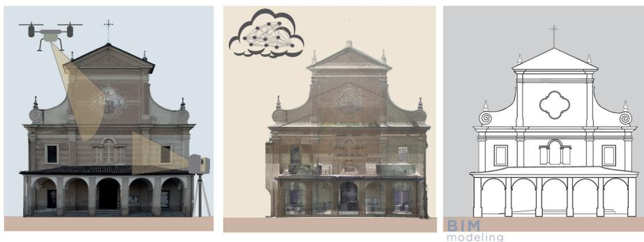
Fig 45 - Schema infografico: dalla nuvola di punti al modello BIM applicato alla facciata del Santuario
