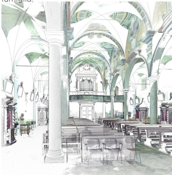
Fig 48 - Vista interna: sovrapposizione elementi modellati e nuvola di punti
