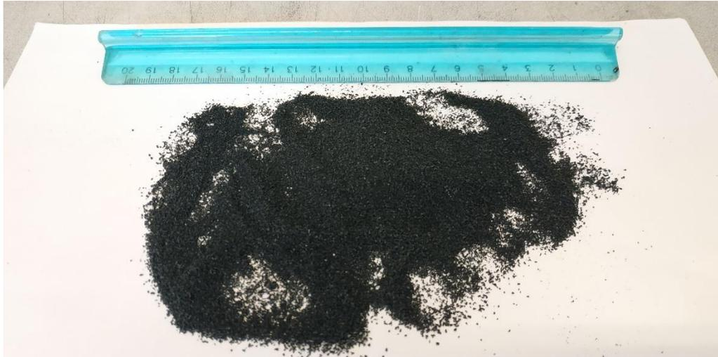
**Figura [7]**, pulverino, con granulometria da 0,2 – 0,8 mm.
