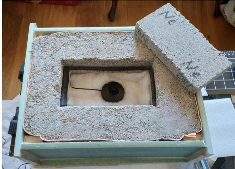
**Figura [58]**, il contenitore per la prova acustica e la camera interna con il microfono.
