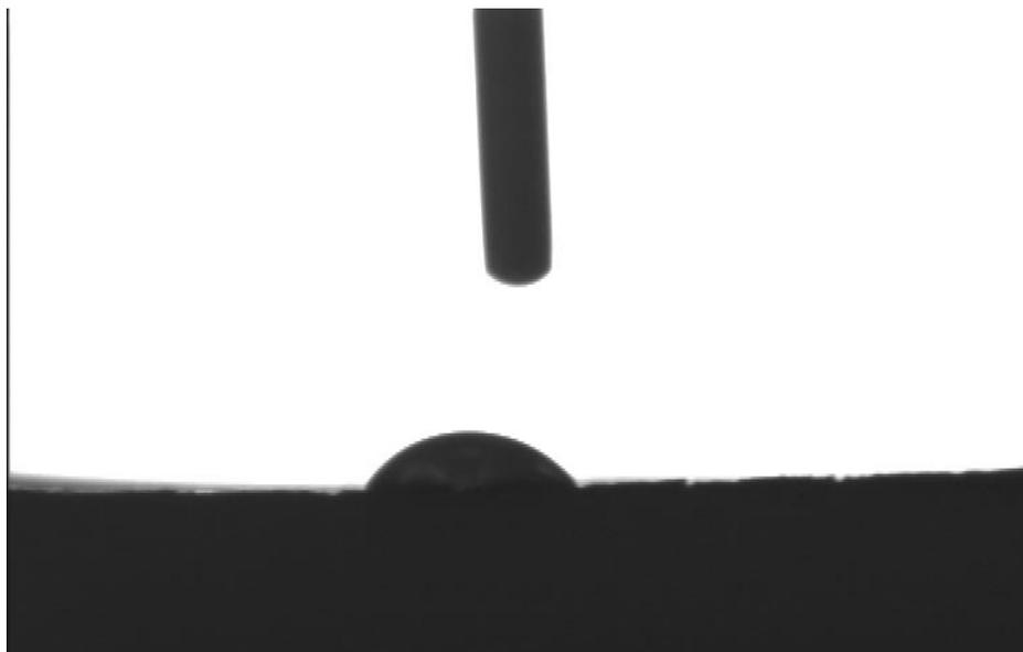
**Figura [33]**, immagine rilevata dallo strumento, quadretto trattato con idrossido di sodio, angolo interno basso, comportamento idrofilo.
