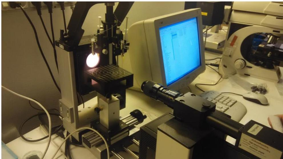
**Figura [12]**, lo strumento per la misura dell'angolo di contatto.
