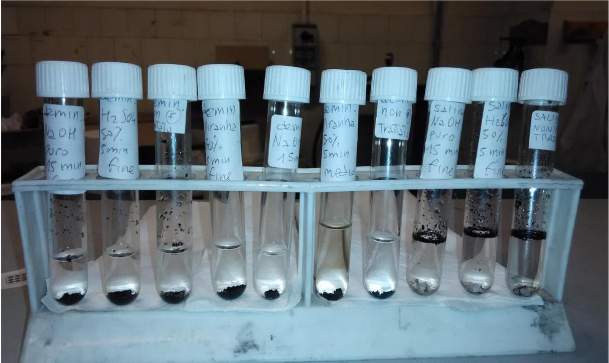
**Figura [36]**, i test di assorbimento d'acqua in corso di svolgimento: i primi sette sono in acqua demineralizzata, gli ultimi tre in soluzione salina satura.
