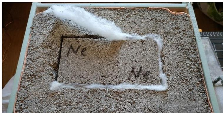
**Figura [59]**, il provino sigillato con la fibra di poliestere.
