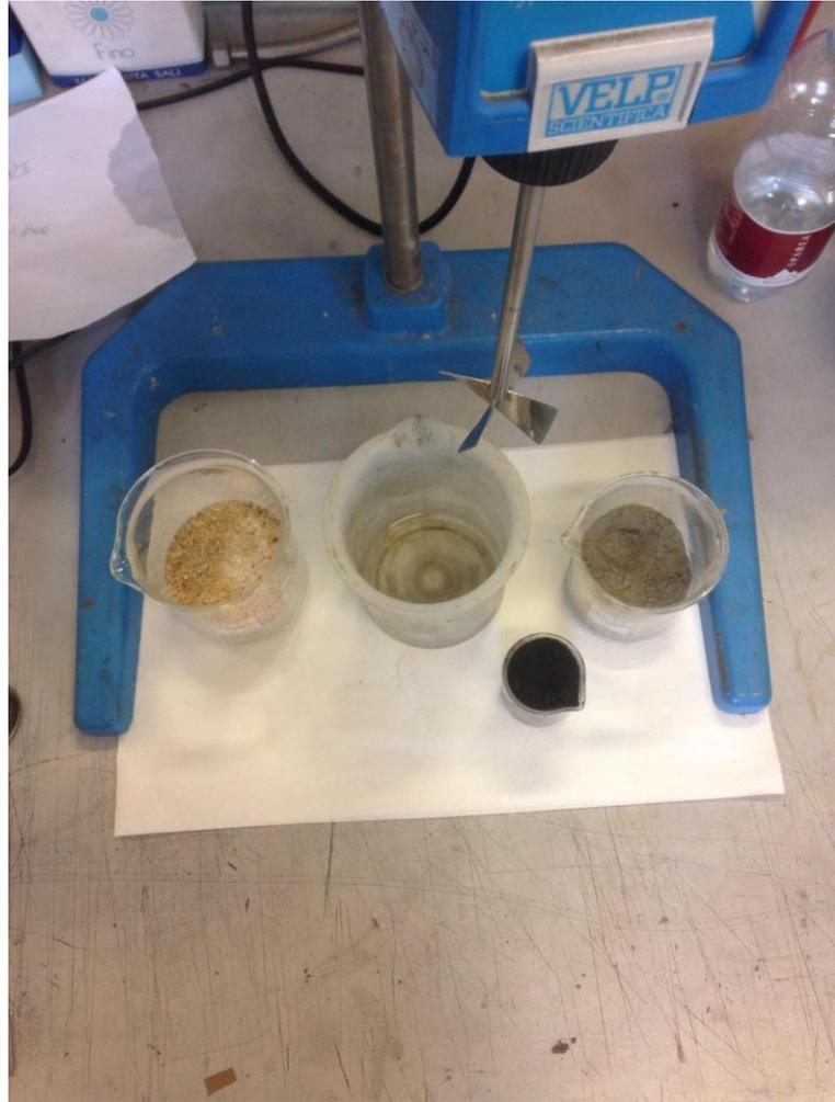
Figura [38], il miscelatore utilizzato nella composizione delle malte con i componenti pesati.
