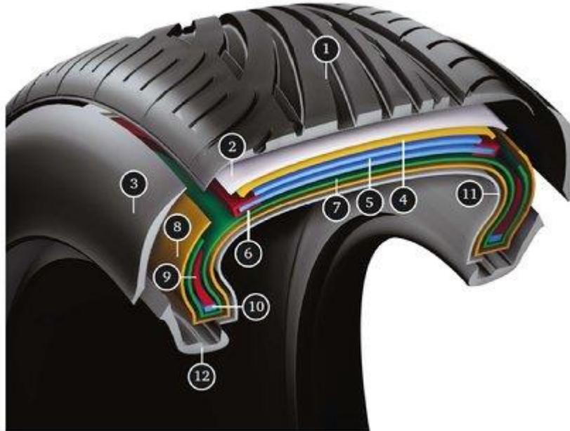
**Figura [1]**, sezione trasversale di uno pneumatico radiale: Battistrada (1), sotto battistrada (2), fianco o spalla (3), NOH rete nylon (4), cintura strato 1 e 2 (5), anello copri cintura (6), carcassa strato 2 (7), carcassa strato 1 (8), striscia di riempimento tallone (9), tallone (10), rivestimento interno (11), anello di bordo in gomma (12)<sup>[7]</sup>.
