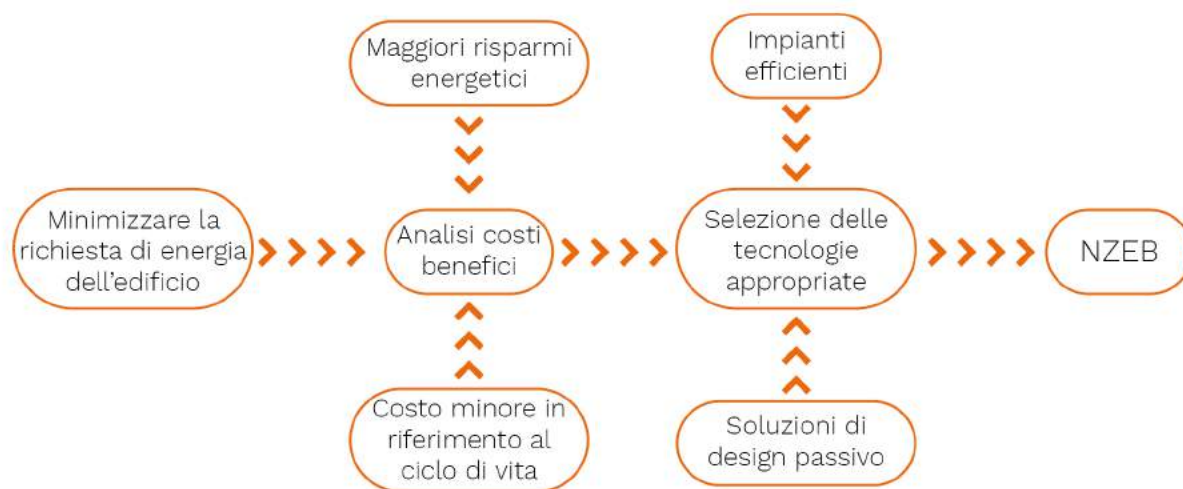
Fig.9 Concetto su cui si fonda l'edificio nZEB
