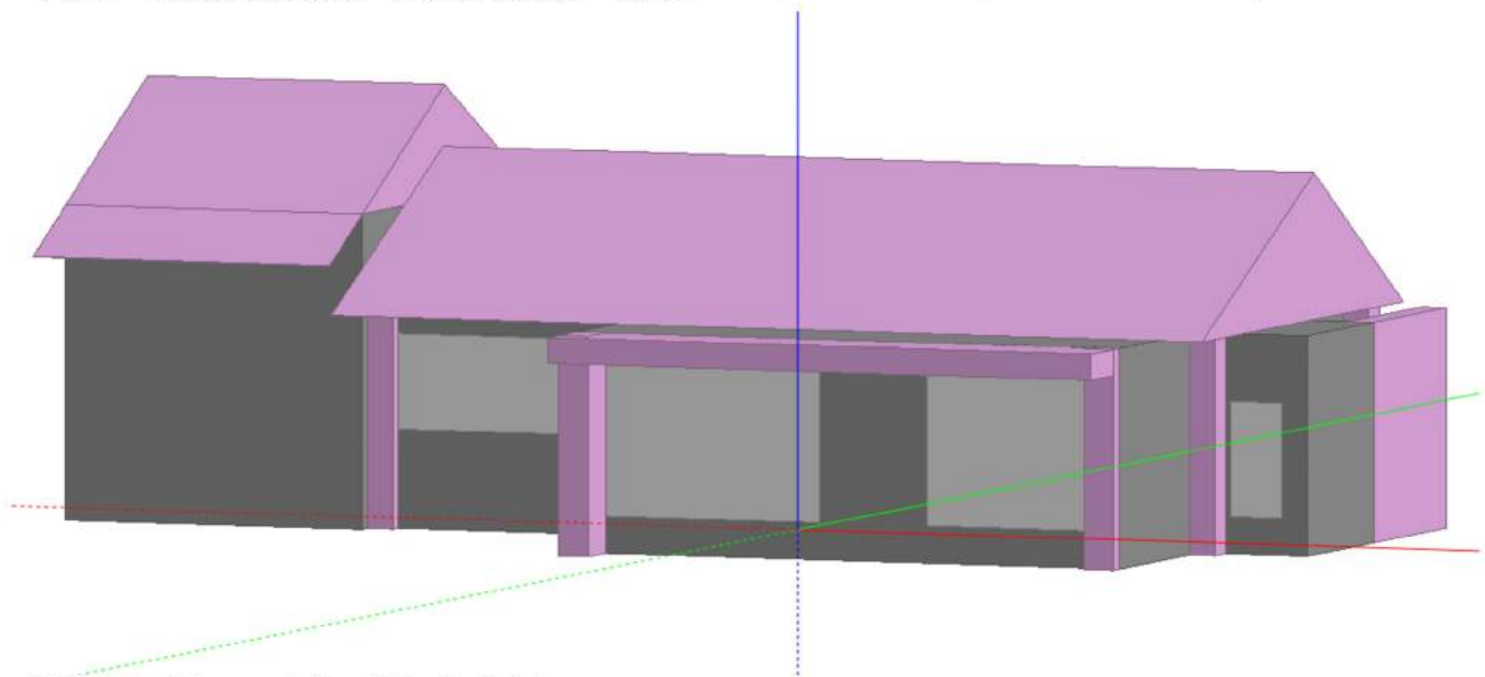
Fig.30 Modello energetico di DesignBuilder
