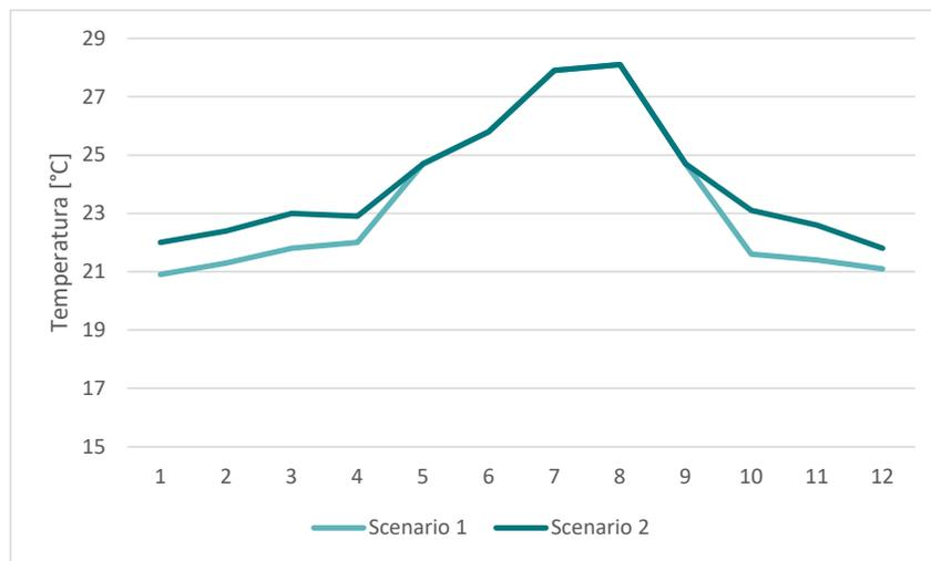
**Figura 64.** Grafico che mostra l'andamento delle temperature medie mensili degli Scenari 1 e 2 all'interno del Foyer al piano primo.
