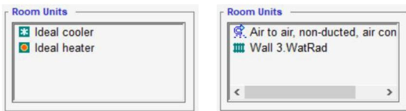
**Figure 54 e 55.** Nella sezione *room units* presente in ogni ambiente è possibile modellare i terminali. Nelle figure viene mostrata la sostituzione degli *ideal room units* degli uffici con i terminali reali, ovvero i radiatori e gli split.
