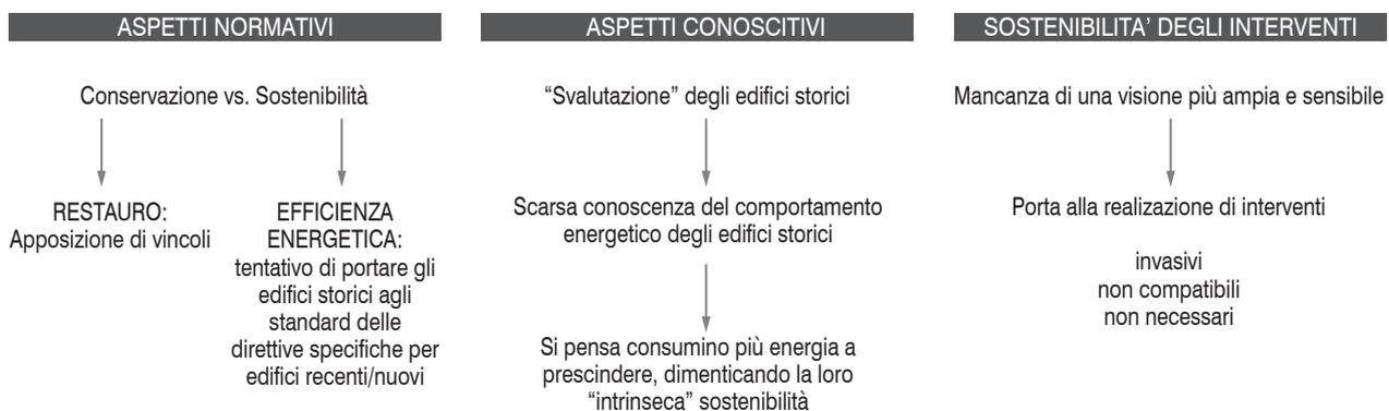
Figura 6. Schematizzazione delle principali criticità riscontrate in letteratura nelle pratiche di efficientamento energetico di edifici storici.
