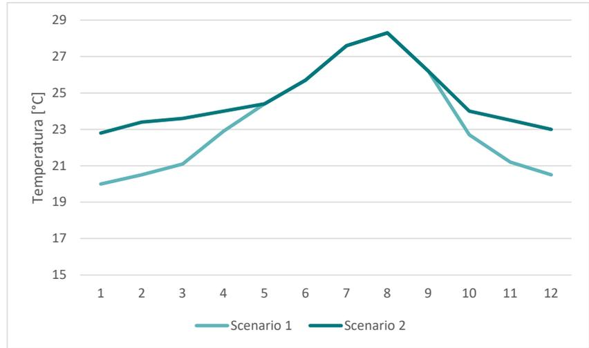
**Figura 62.** Grafico che mostra l'andamento delle temperature medie mensili degli Scenari 1 e 2 all'interno delle aule 22-26 site al secondo piano.
