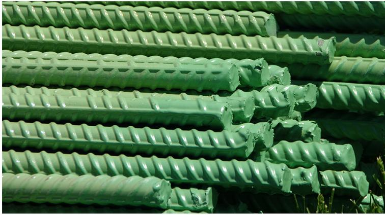
Figura 4.9: Protezione polimerica per armatura
