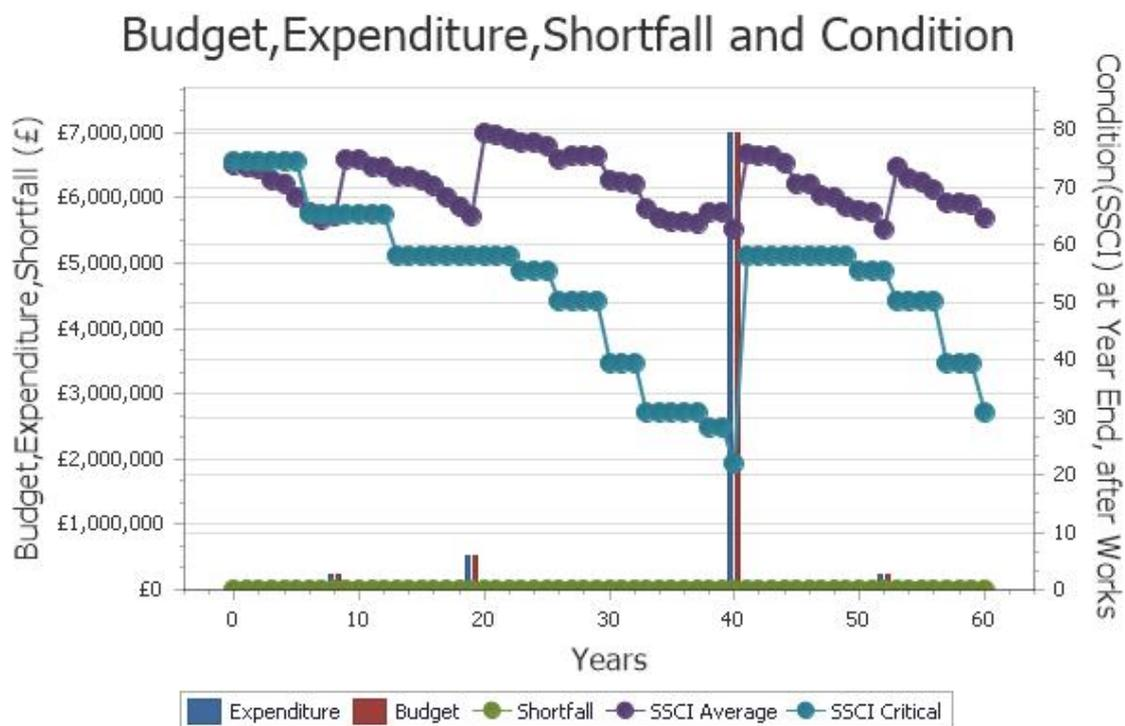
Figura 6.28: Andamento della condizione media e critica del viadotto 2 con la strategia planned do minimum
