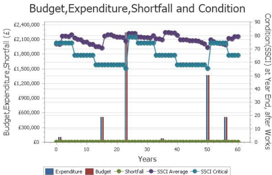
Figura 6.26: Andamento della condizione media e critica del viadotto 2 con la strategia planned preventative
