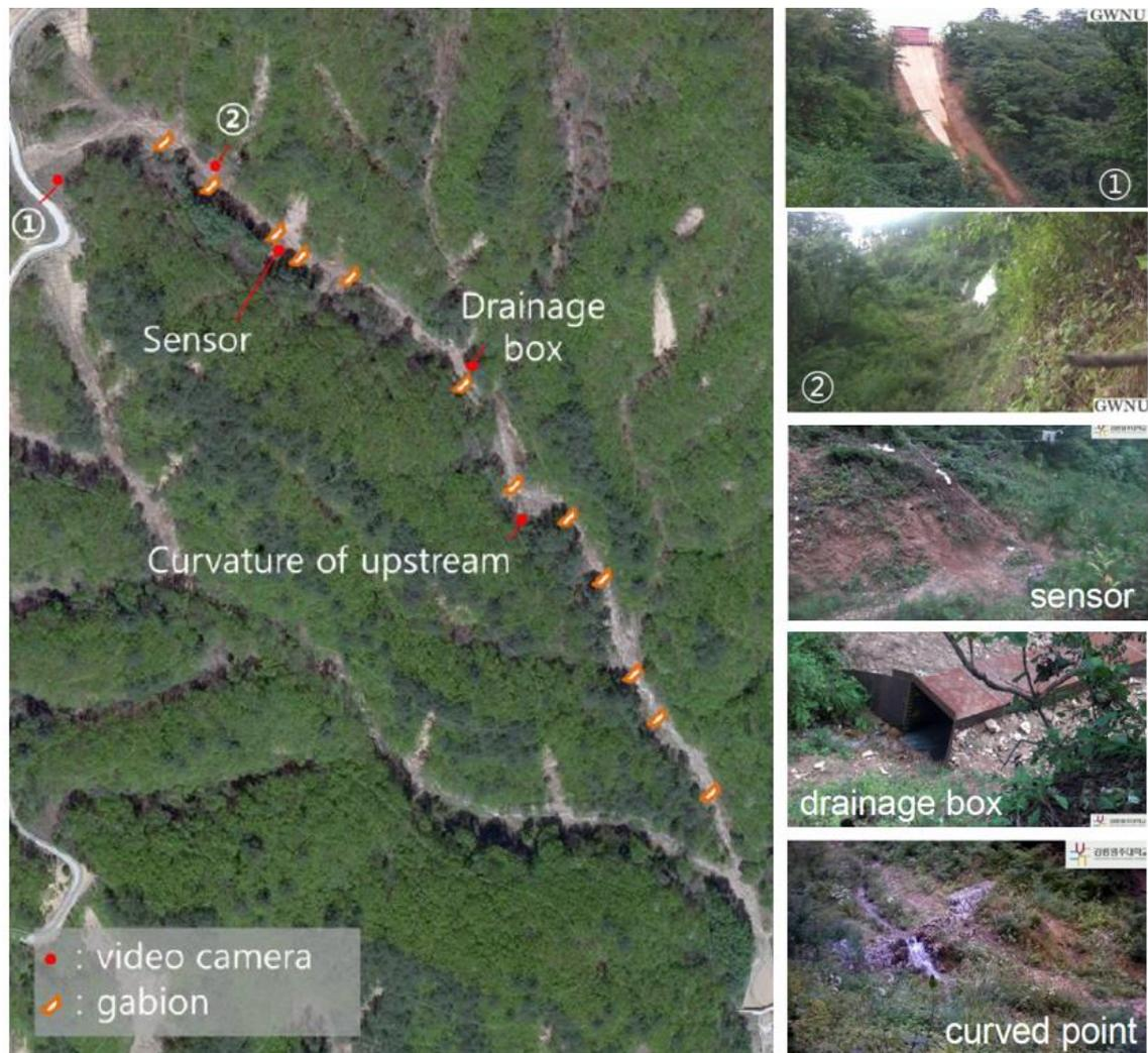
Figura 105: test 1, posizione delle videocamere (punti 1, 2 e in corrispondenza della canaletta), dei sensori (celle di carico, sensori a ultrasuoni, celle piezometriche), e canaletta a sezione quadrata (Chan & Kyung, 2016)
