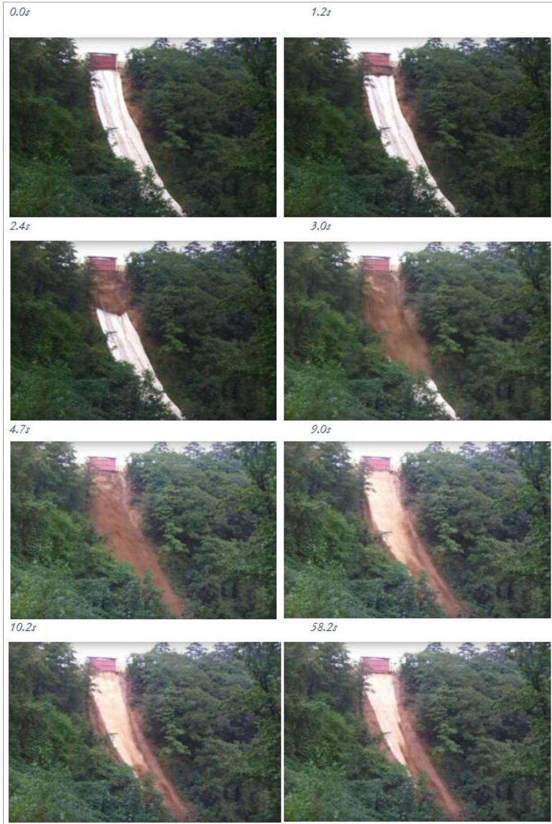
Figura 106: Test 1, sequenza temporale del rilascio del miscuglio terreno-acqua, videocamera in posizione 1 della figura 105
