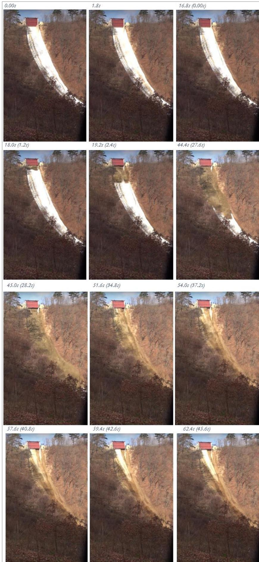
Figura 113: Test 2, sequenza temporale del rilascio del miscuglio terreno-acqua, videocamera in posizione 1 della figura 109
