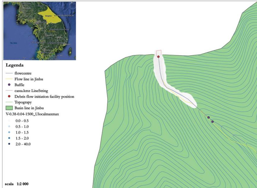
Figura 170: area inondata e distribuzione areale delle velocità massime - legge Voellmy  $\text{frictionCoeffFluid}=0.38$ ,  $\text{particleDiameter}=0.04$ ,  $\text{particleDensity}=1500$
