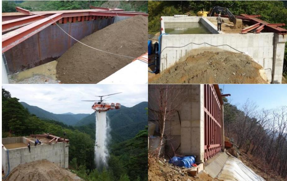
Figura 104: procedura innescò debris flow artificiale a scala reale (Chan & Kyung, 2016)
