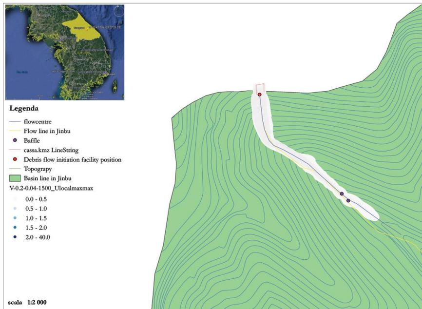
Figura 171: area inondata e distribuzione areale delle velocità massime - legge Voellmy  $\text{frictionCoeffFluid}=0.20$ ,  $\text{particleDiameter}=0.04$ ,  $\text{particleDensity}=1500$
