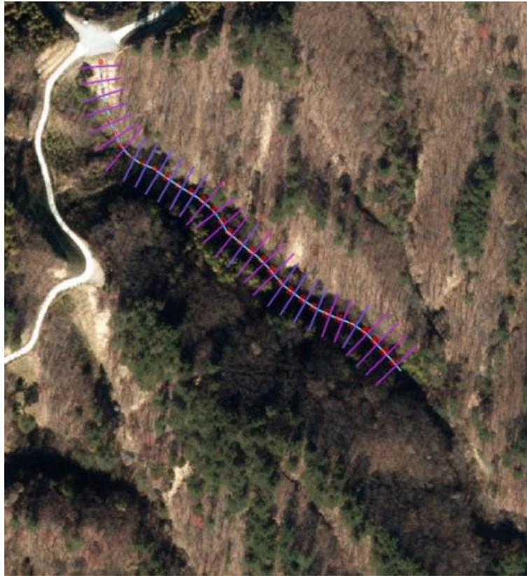
Figura 120: vista areale della posizione della linea di sezione longitudinale (discretizzazione 10m) e trasversale (discretizzazione 1m) (Chan & Kyung, 2016)
