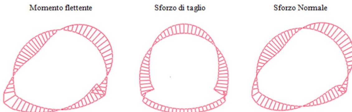
Figura 4.4.2: Sollecitazioni derivanti dall'analisi dinamica semplificata 3D, con transizione stratigrafica
