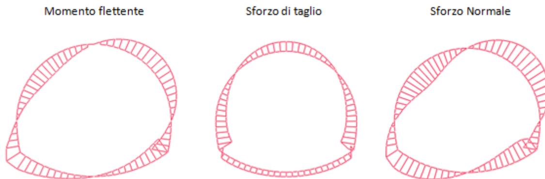
*Figura 4.4.4: Sollecitazioni derivanti dall'analisi dinamica completa 3D, con transizione stratigrafica*
