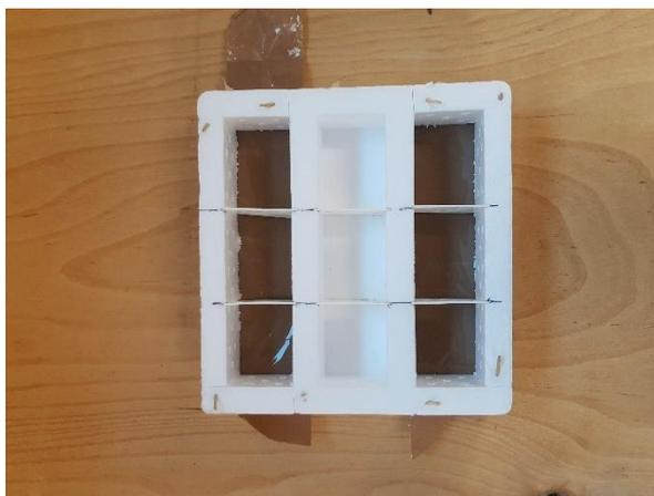
Figura 33 - Stampi speciali per test a compressione a  $t=3h$
