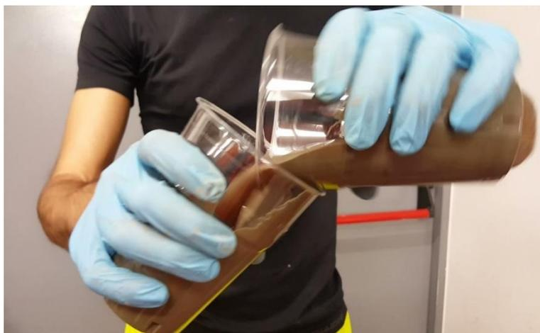
*Figura 30 - Esecuzione prova di gel time*
