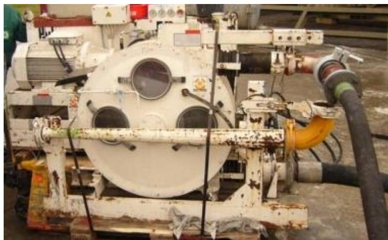
*Figura 15 - Pompa peristaltica*
