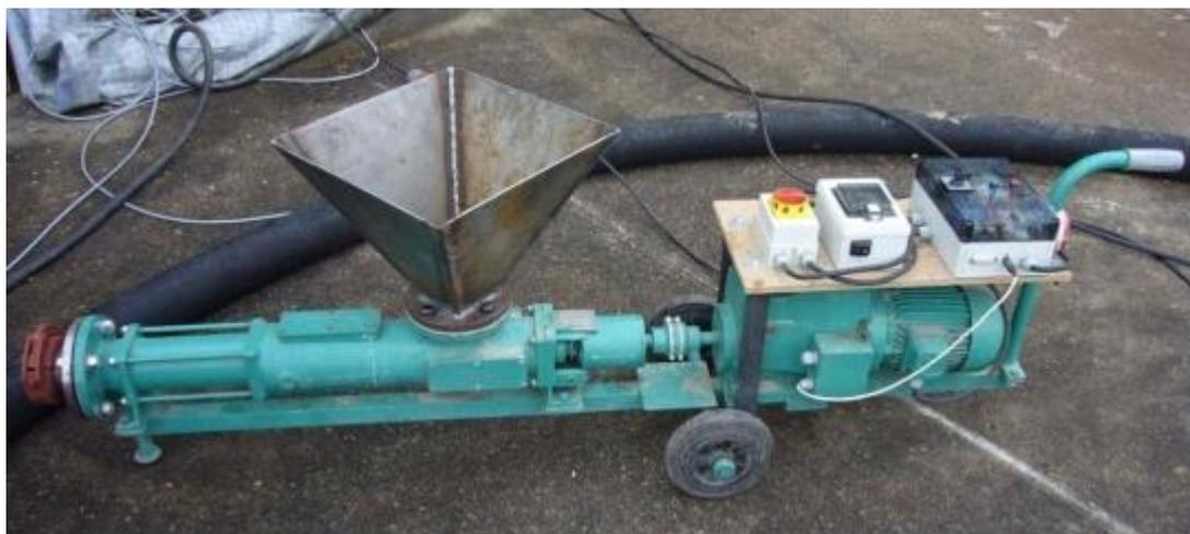
*Figura 16 - Pompa a cavità progressiva*
