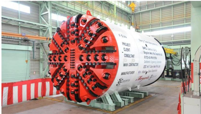
*Figura 4 - EPB-Shield TBM*
