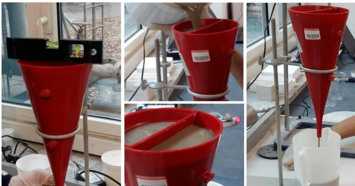
*Figura 28 - Test di fluidità. Il riempimento del cono Marsh e le misure del flusso sono mostrati rispettivamente al centro e a destra.*
