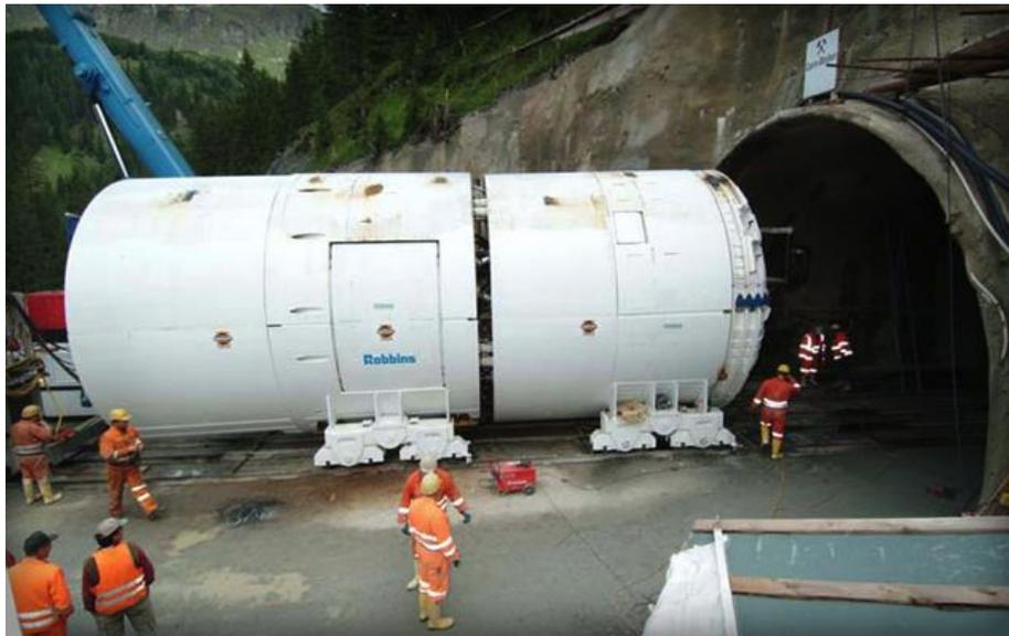
*Figura 3 - Double Shield TBM*
