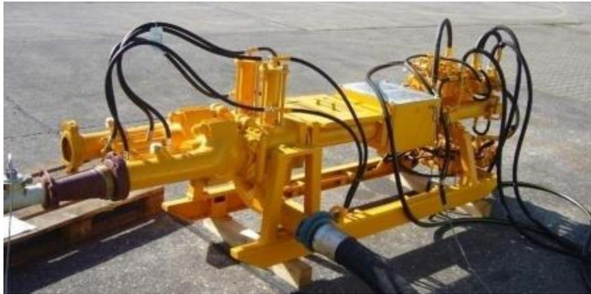
*Figura 14 Pompa a doppio pistone con linea di alimentazione di malta*
