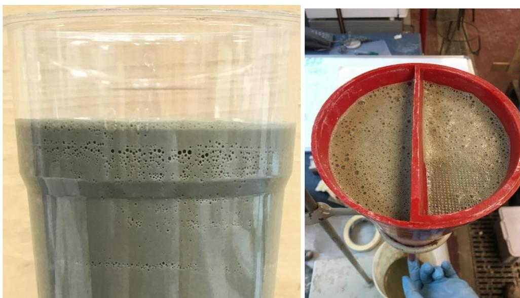
Figura 50 - Bolle d'aria inglobate all'interno della malta
