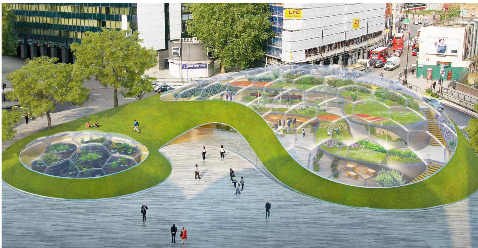
[Fig. 26] Concept del progetto Mobius. Il materiale previsto per la copertura è un polimero ad alta resistenza, ovvero l'ETFE, il quale può coprire superfici sette volte superiori a quelle del vetro, con un peso pari a un centesimo rispetto a quello del sistema a doppi vetri. Photo credit Exploration©
