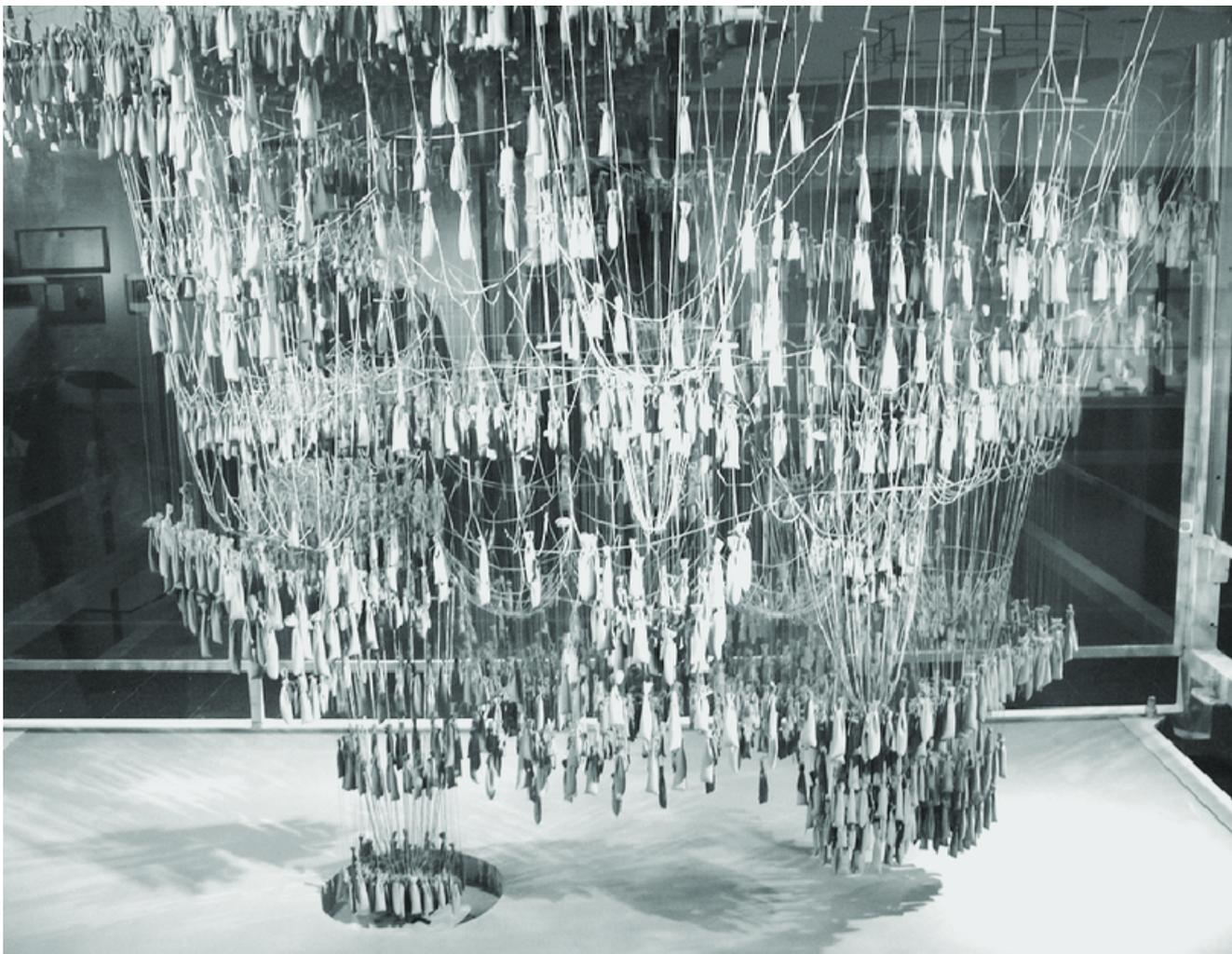
[Fig. 61] "Modello appeso" ideato per la Sagrada Família, con un sistema di corde e sacchi di juta. In molti dei suoi progetti Gaudí utilizzò questo metodo pratico, che gli permise di realizzare calcoli più rapidamente rispetto ai metodi più tradizionali dell'epoca. Photo credit Josep Maria Puche©.
