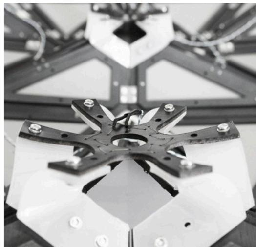
[Fig. 44] Proposta progettuale del programma *Translated Geometries*, IAAC. Il disegno a tassellatura triangolare ha favorito una grande flessibilità e ha reso la struttura più pieghevole. L'ispirazione deriva dall'artista di origami Ron Resch. Photo credits IAAC©
