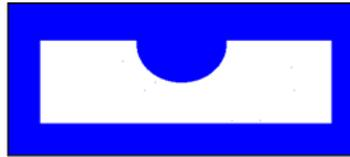
Fig. 10.8 – ROI utilizzata per la DIC-2D in un provino forato.
