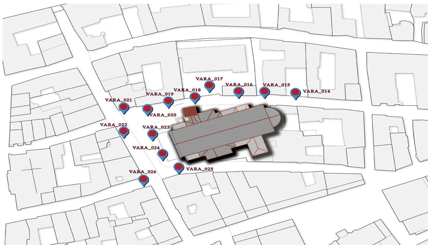
Schema posizionamento del Laser Scanner fisso
