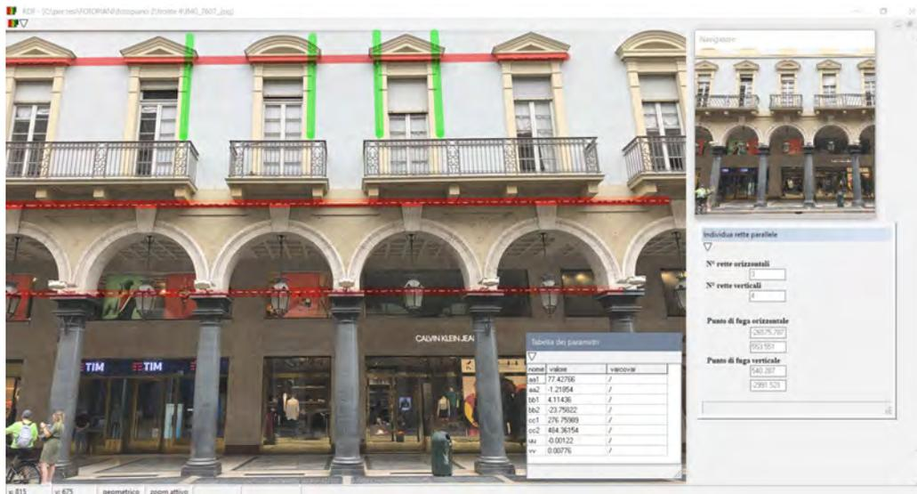
2. La prima operazione necessaria è stata l'inserimento dei vincoli geometrici rispetto a linee ipotizzate orizzontali e verticali sul piano da raddrizzare.
