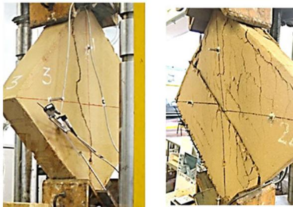
**64 ▲ Test di compressione diagonale.** A sinistra il provino non rinforzato, a destra quello rinforzato.
