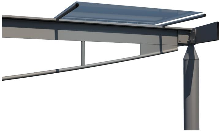
Fig. 92 - Schema del nodo trave-pilastro della copertura.
