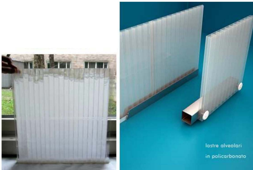
Figure 56- Prototype of polycarbonate alveolar panels to contain PCM, by Bruno Giampà e Gianluca Gindro, "Inerzia trasparente: definizione progettuale e validazione sperimentale di un componente di facciata in polycarbonato alveolare e PCM" Politecnico di Torino ,2010
