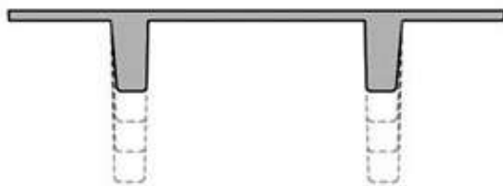
Figura 7.6: tipologia di elemento in c.a. prefabbricato "pigreco".
