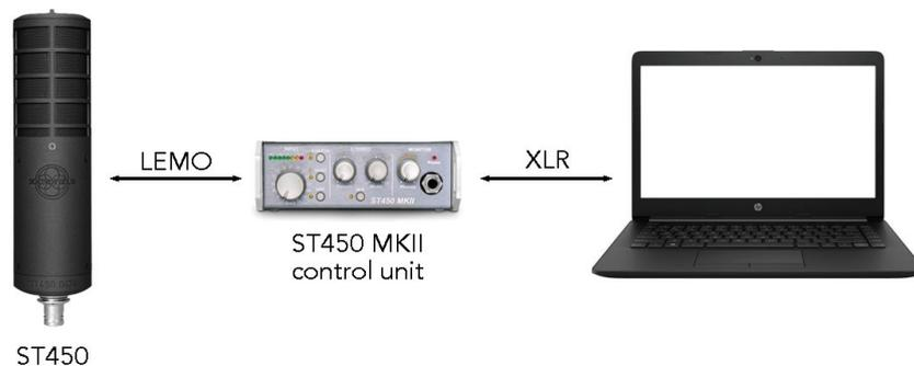
Figura 5.6: Setup base per l'utilizzo di SoundField ST450.
