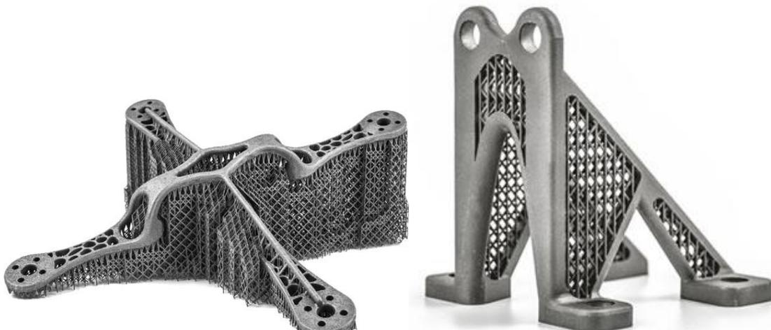
*Figura 5 - Supporti su superfici non visibili e supporti integrati come strutture lattice*
