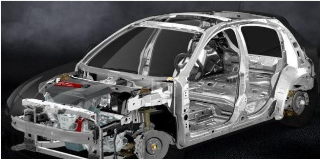
*Figura 49 - Telaio Alfa Romeo Giulietta*
