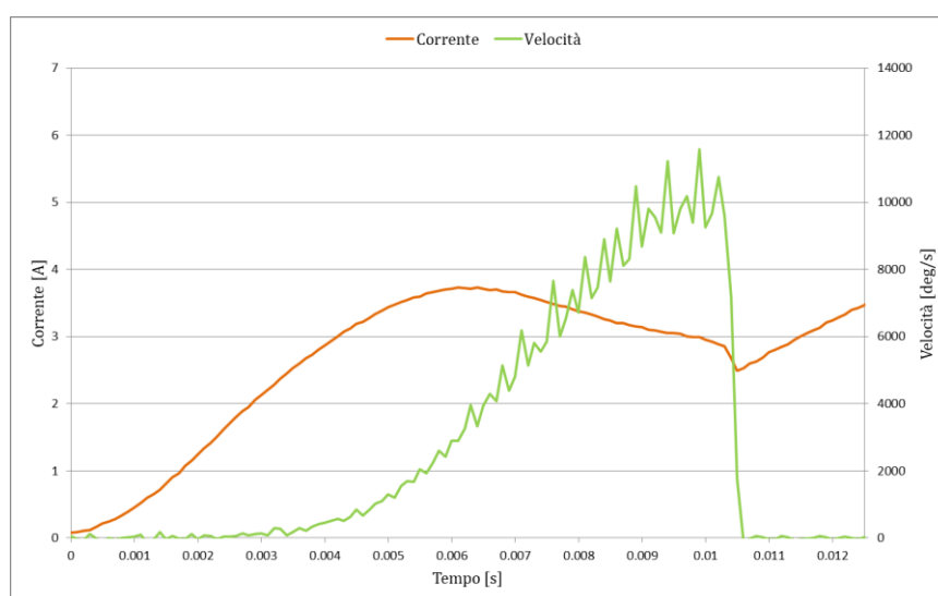
Figure 70 - Confronto tra corrente assorbita e rotazione in attivazione
