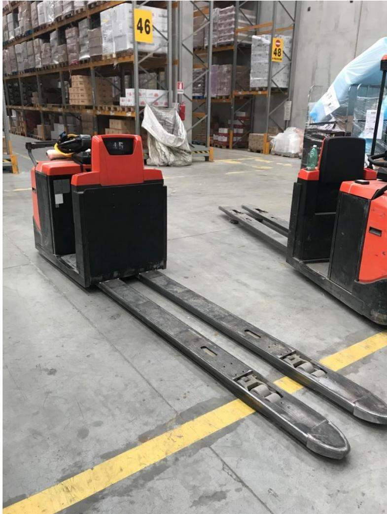
*Figura 3.10 Transpallet elettrico utilizzato nel processo di picking (fonte: foto scattata in azienda)*
