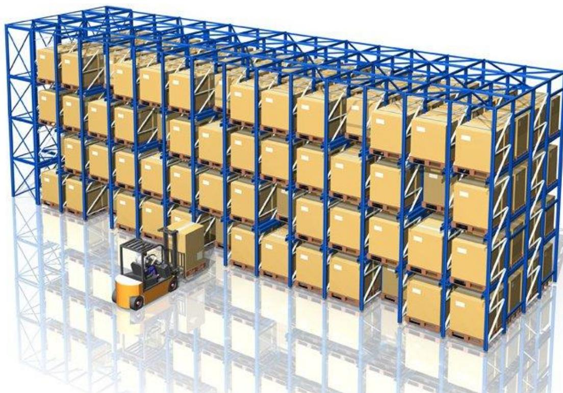
*Figura 3.3 esempio di scaffalatura drive-in (fonte: www.sacmaspa.com)*
