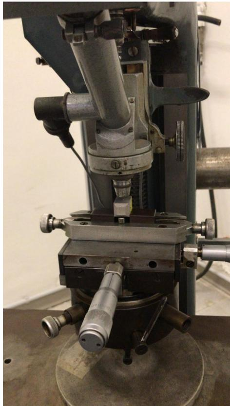
*Fig. 4.11: Durometro Crayford utilizzato per le prove Brinell 10-1*
