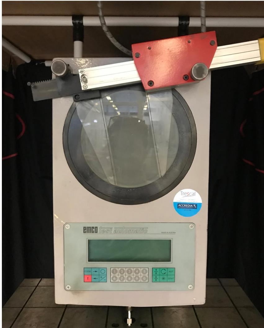
Fig. 4.10: Durometro EmcoTest utilizzato per le prove Brinell 62.5-2.5
