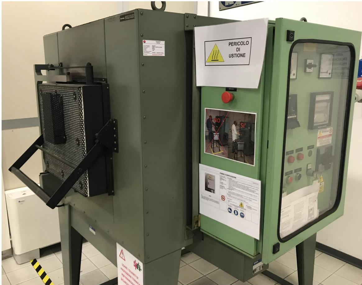
Fig. 4.5: Forno industriale utilizzato per l'esecuzione dei trattamenti termici
