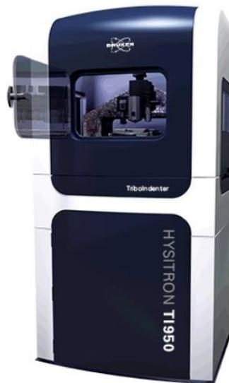
Fig. 4.8: Tribometro Hysitron TI 950
