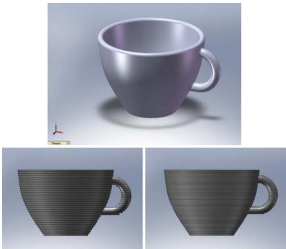
*Fig. 1. 1 Immagine CAD di una tazza con altre immagini che mostrano la differenza del risultato finale in funzione dello spessore del layer*
