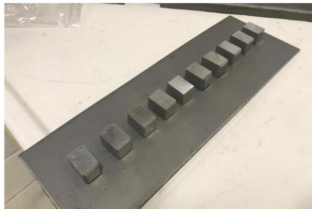
*Fig. 4.3: Lucidatrice – Presi – (CRF); Provini dopo il trattamento di lucidatura*
