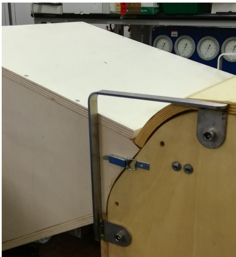
Figura 38 Dispositivi di chiusura a ginocchiera – montaggio esterno
