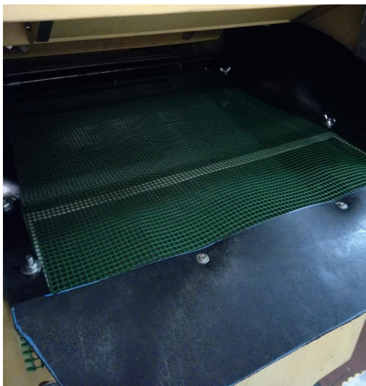
Figura 69 Rete di plastica sostituita
