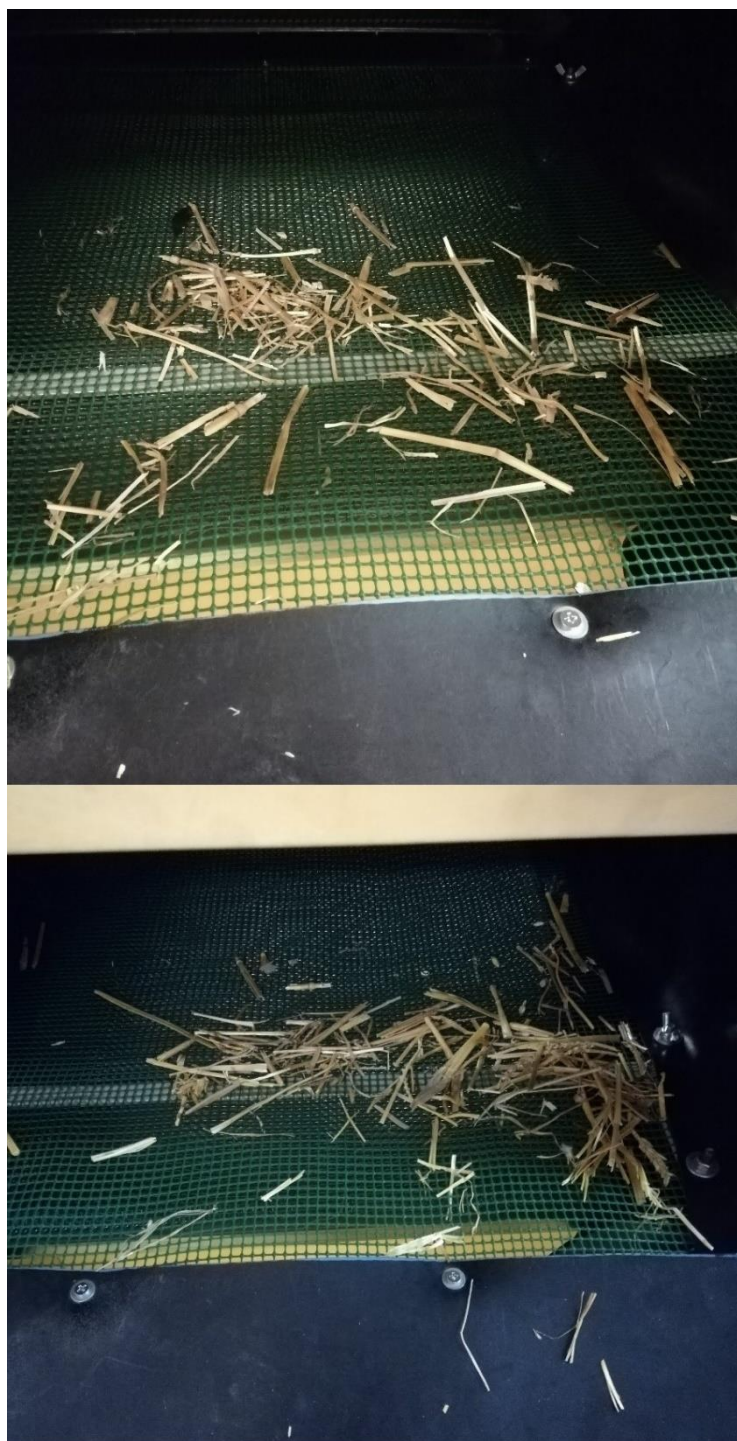
Figura 71 Risultati test pulitura: paglia correttamente depositata sulla griglia
