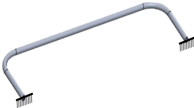
Figura 133-Schema strutturale equivalente braccio fisso
