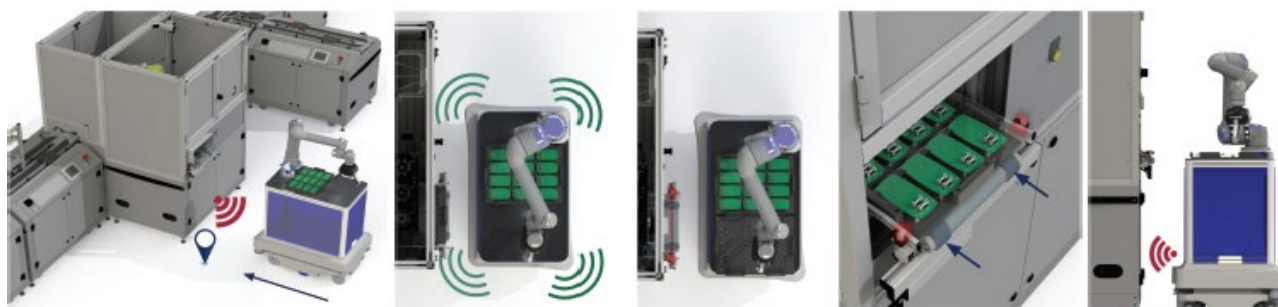
Figura 2-20: Robot per rifornimento "a chiamata"
