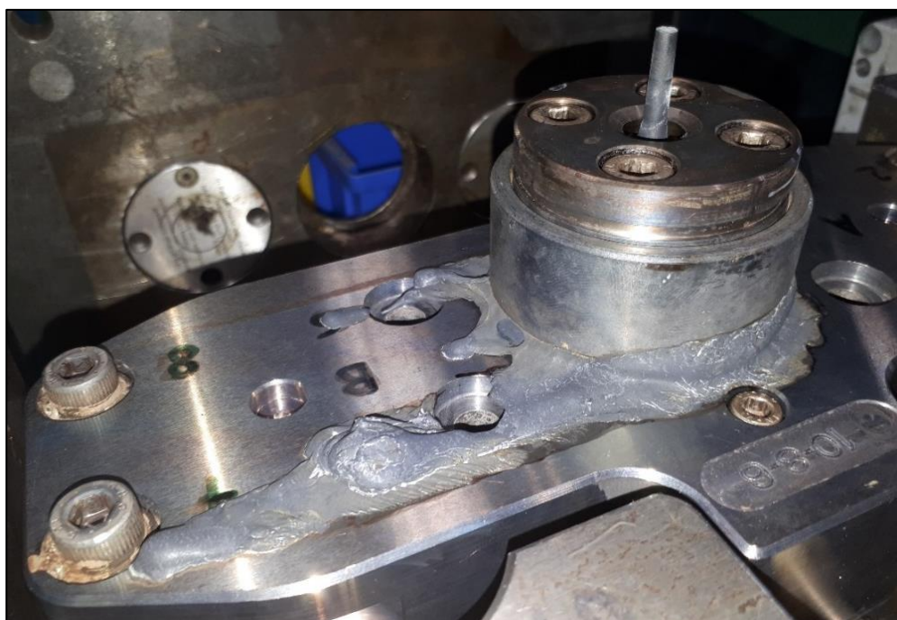
Figura 5.35 – Perdita di materiale tra la boccola di iniezione e il distributore durante la seconda prova con teste senza superficie ridotta; tra le gli ugelli e il distributore non si sono verificate perdite.
