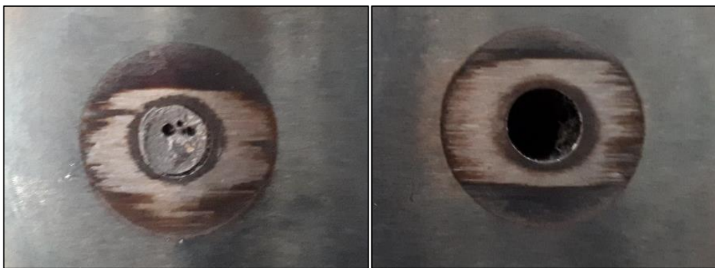
Figura 5.34 – Impronte sulla superficie del distributore in corrispondenza dell'ugello A (destra) e B (sinistra) al termine della prima prova con teste senza superficie ridotta: si notano delle macchie nere lasciate dai gas intorno al canale di colata.
