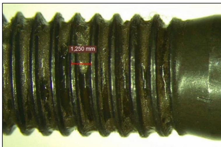
Figura 5.22 – Misurazione al microscopio del passo della filettatura della vite numero 1 al termine del test a banco con viti serrate a 35 Nm.
