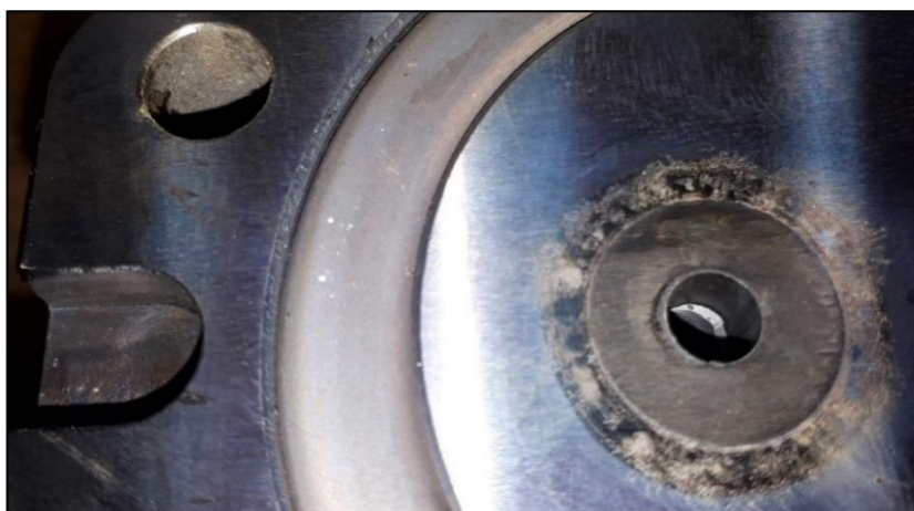
Figura 5.31 – Impronta sulla superficie della camera calda in corrispondenza dell’ugello A al termine della seconda prova: si osservano delle macchie nere causate dalla frazione gassosa del polimero.
