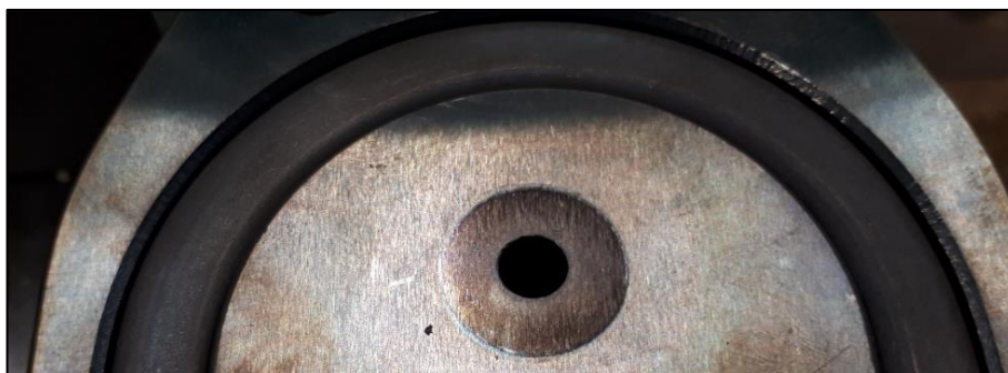
Figura 5.30 – Impronta sulla superficie della camera calda in corrispondenza dell’ugello B al termine della prima prova con due viti: non si notano graffi o macchie di plastica intorno al canale di colata.
