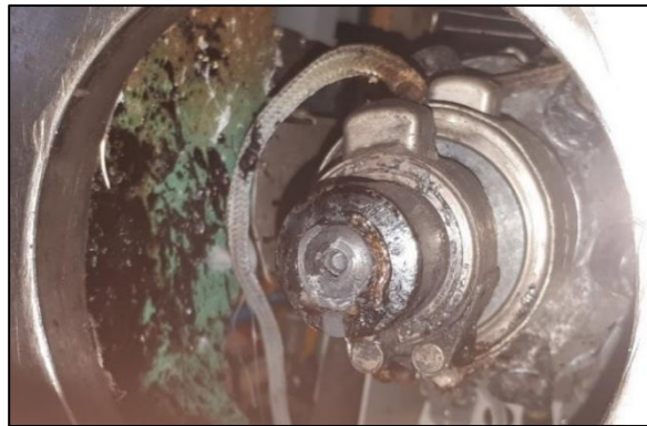
Figura 5.24 – Immagine dell'ugello della pressa che va in battuta sulla boccola di iniezione dello stampo: si ha il rischio che possa generare una forza sufficiente a "impaccare" l'intero sistema e invalidare i risultati delle prove.
