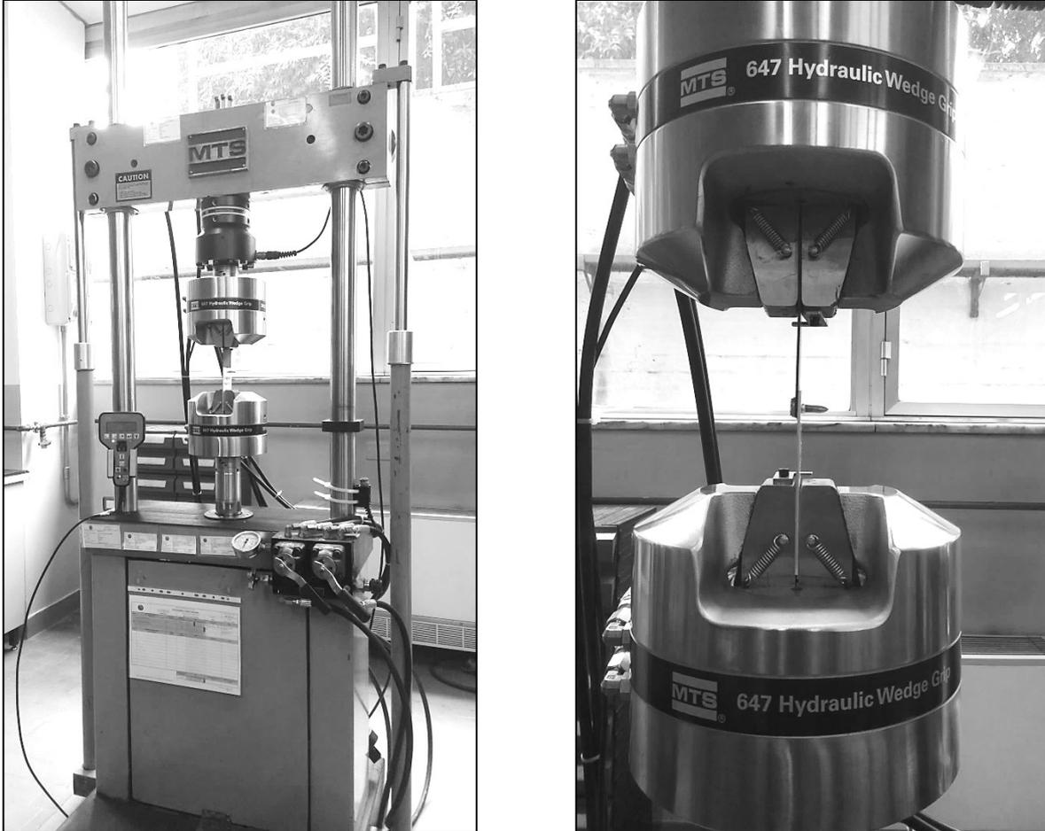
*Fig. 3.2 Macchina per prova trazione e morsetto a cuneo*
