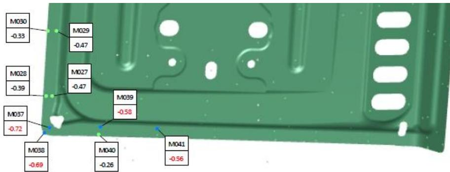
Figura 58 Ingrandimento del report di misura del P/N 84558480 1/2
