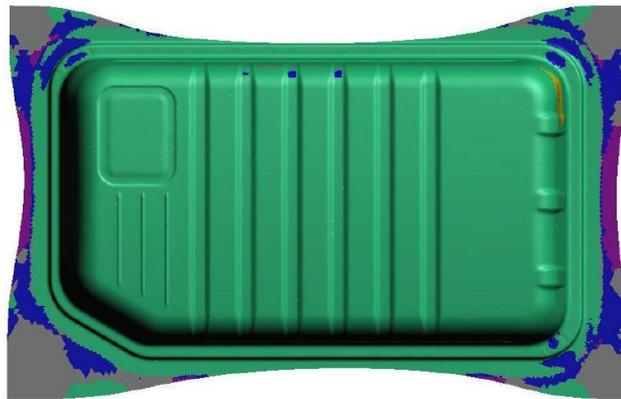
*Figura 8 Simulazione di imbutitura tramite software*
