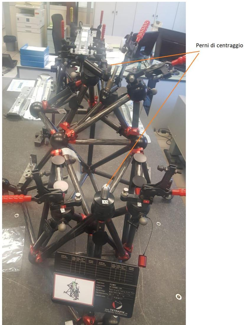
Figura 88 Immagine del calibro con i perni di centraggio
