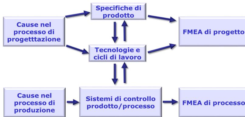
Figura 71 Processo dell'analisi FMEA
