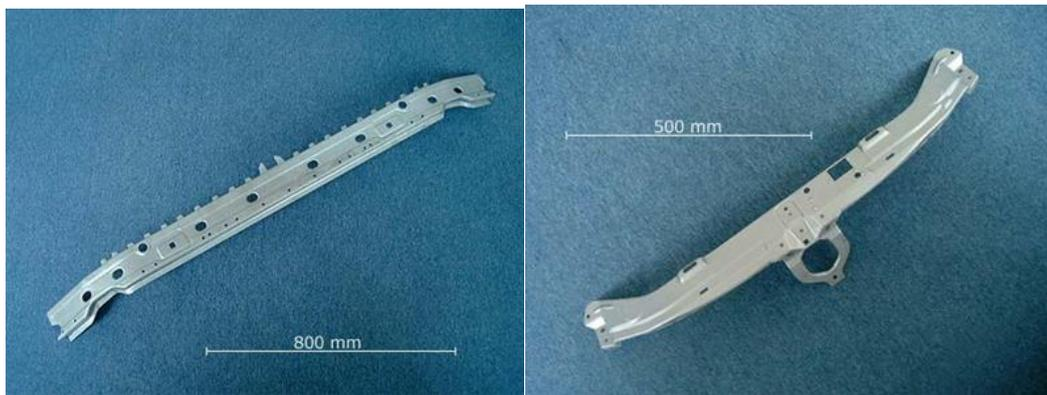
*Figura 1 Particolari prodotti in IMC tramite stampaggio a freddo*
