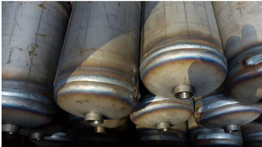
*Figura 5 Serbatoio prodotto utilizzando la linea di saldatura TIG*
