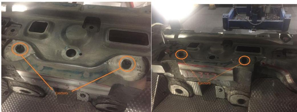
*Figura 31 Posizionamento estrattori sulla matrice*
