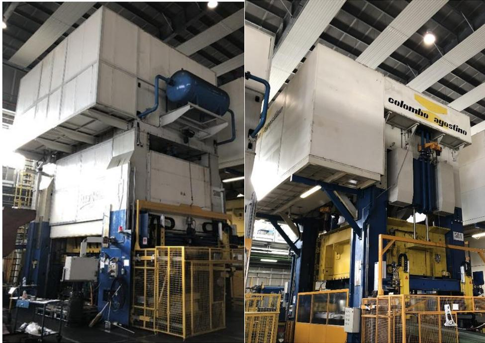
*Figura 2 Presse IMV 2500 Ton (sx) e Colombo Agostino 3000 Ton (dx) transfer/progressiva*
