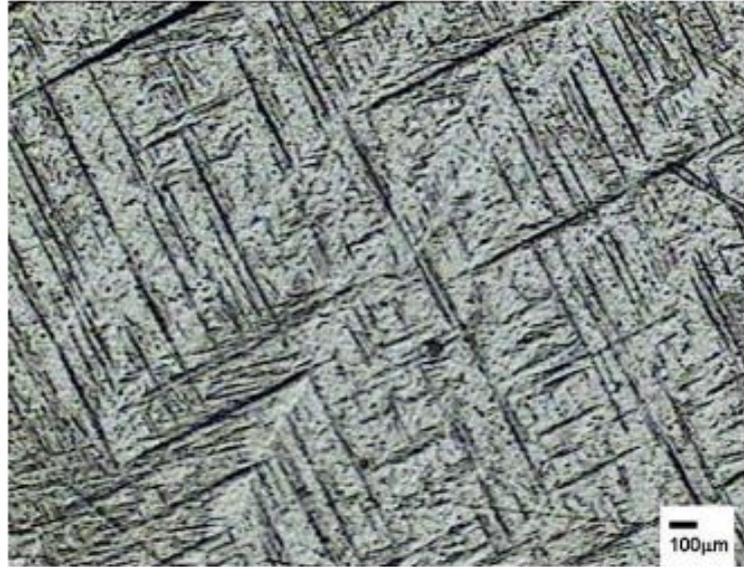
**Figura 4.10: Struttura martensitica del Ti-6Al-4V ottenuta tramite processo di tempra<sup>47</sup>**
