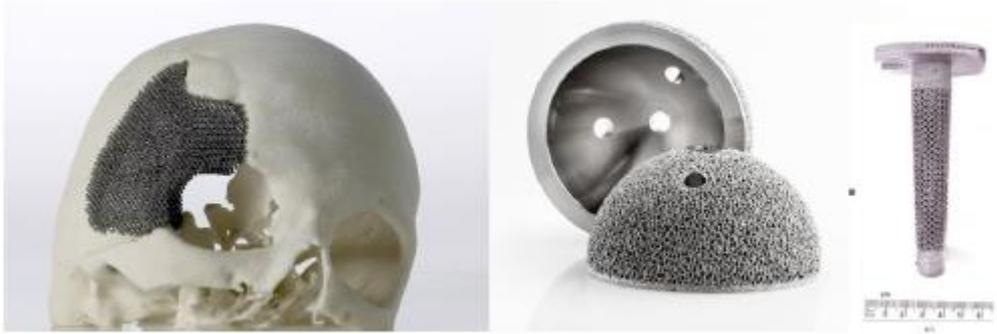
**Figura 2.25: Impianti medicali realizzati in Ti-6Al-4V tramite processo EBM<sup>39</sup>**
