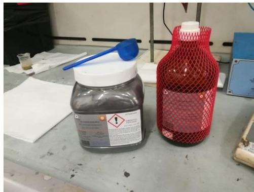
**Figura 3.11: Resina utilizzata per l'inglobamento dei provini**
