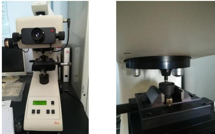
**Figura 3.23: Durometro utilizzato per la prova di microdurezza Vickers e posizionamento del provino nello strumento**
