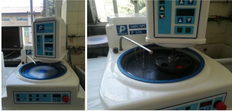
**Figura 3.12: Lucidatrice utilizzata per la preparazione dei provini**
