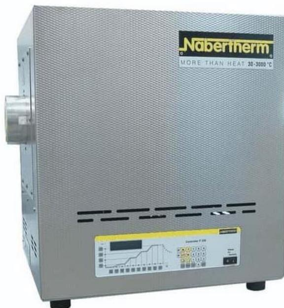
**Figura 3.9: Forno *Nabertherm* utilizzato per l'esecuzione del trattamento HT6 in atmosfera protetta**
