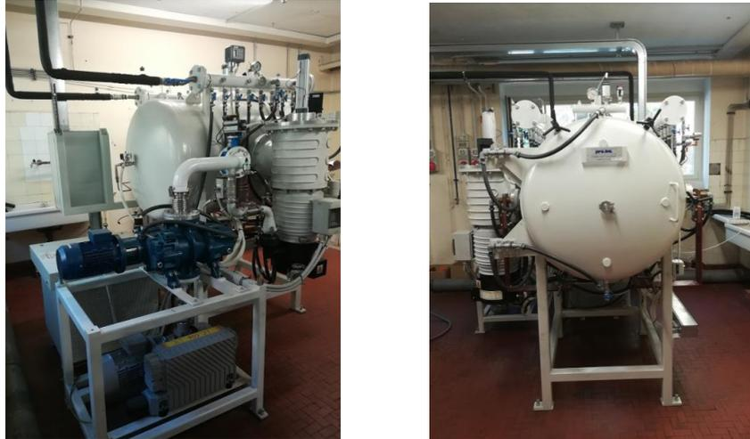
**Figura 3.8: Forno *pro.ba.* utilizzato per l'esecuzione dei trattamenti sottovuoto**
