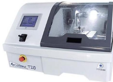
**Figura 3.7: Troncatrice utilizzata per il taglio dei provini**
