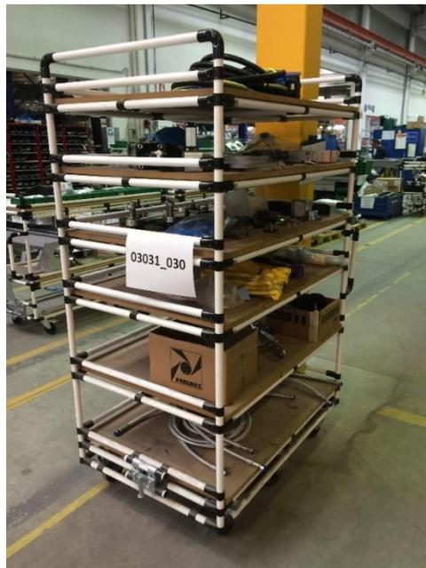
*Figura 24 - Carrello per materiale di dimensioni ridotte*
