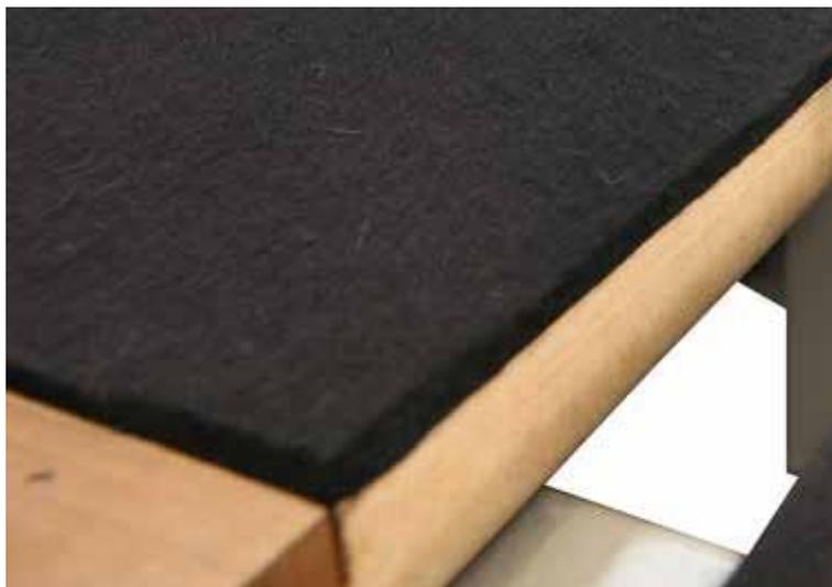
*Figura 11 - Piano in legno MDF con rivestimento di feltro*
