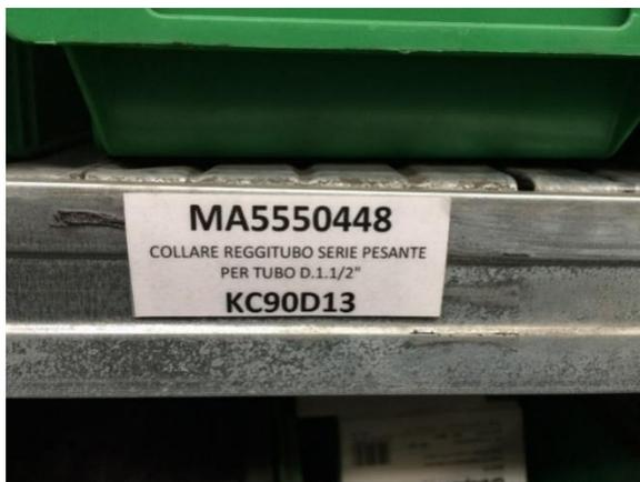
*Figura 14 - Esempio di codice Kanban*
