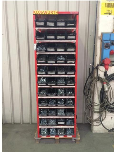
*Figura 48 - Scaffalatura con stoccaggio viteria kanban*
