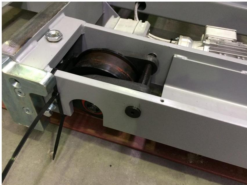
*Figura 69 - Gruppo Ruota montato su Caricatrice*
