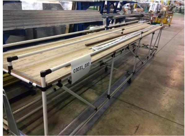
*Figura 23 - Carrello per materiale lungo*
