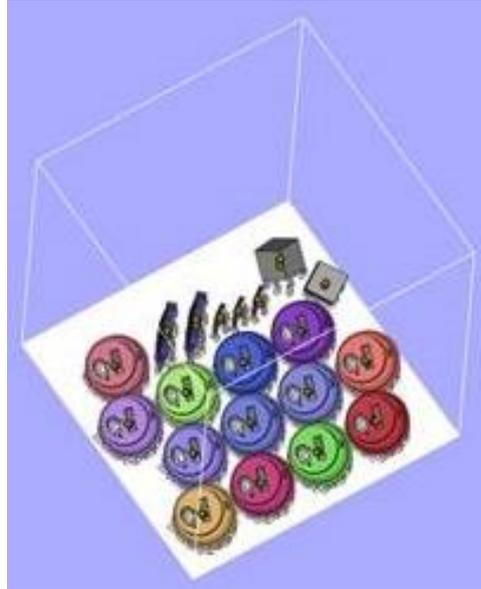
*Figura 4.7 Piano di stampa Stereolitografia*
