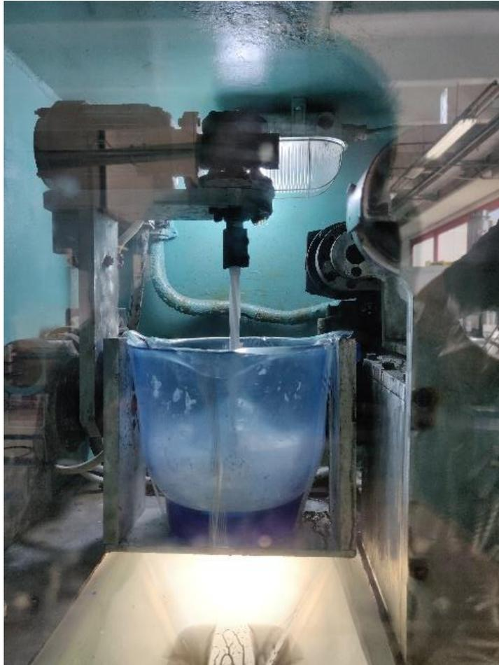
*Figura 4.13 Miscelazione del silicone con il catalizzatore*
