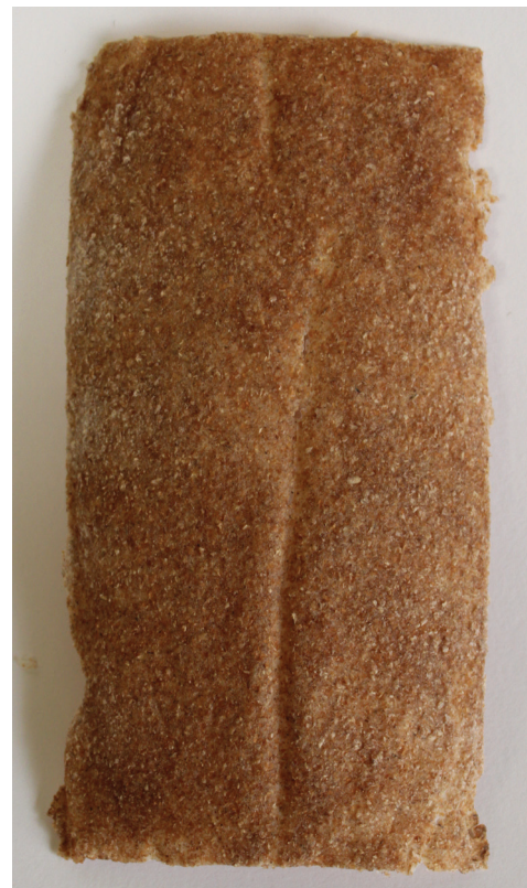
Fig.4.22 a/b ( sotto ) Deformazione della superficie causata dall'esposizione diretta ad aria calda.
