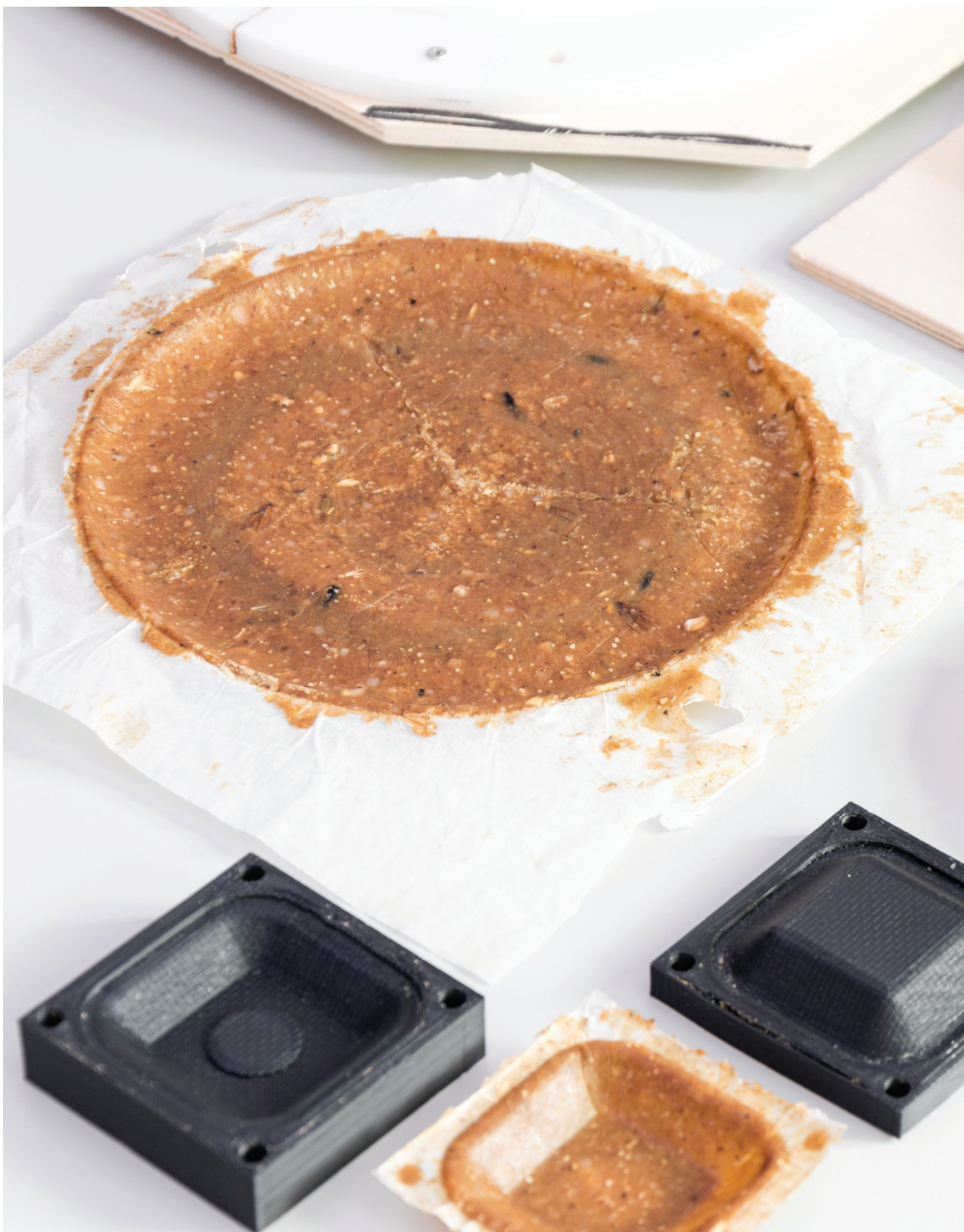
Fig.4.37 Matrici in PLA e relativi test formati in pressa.
