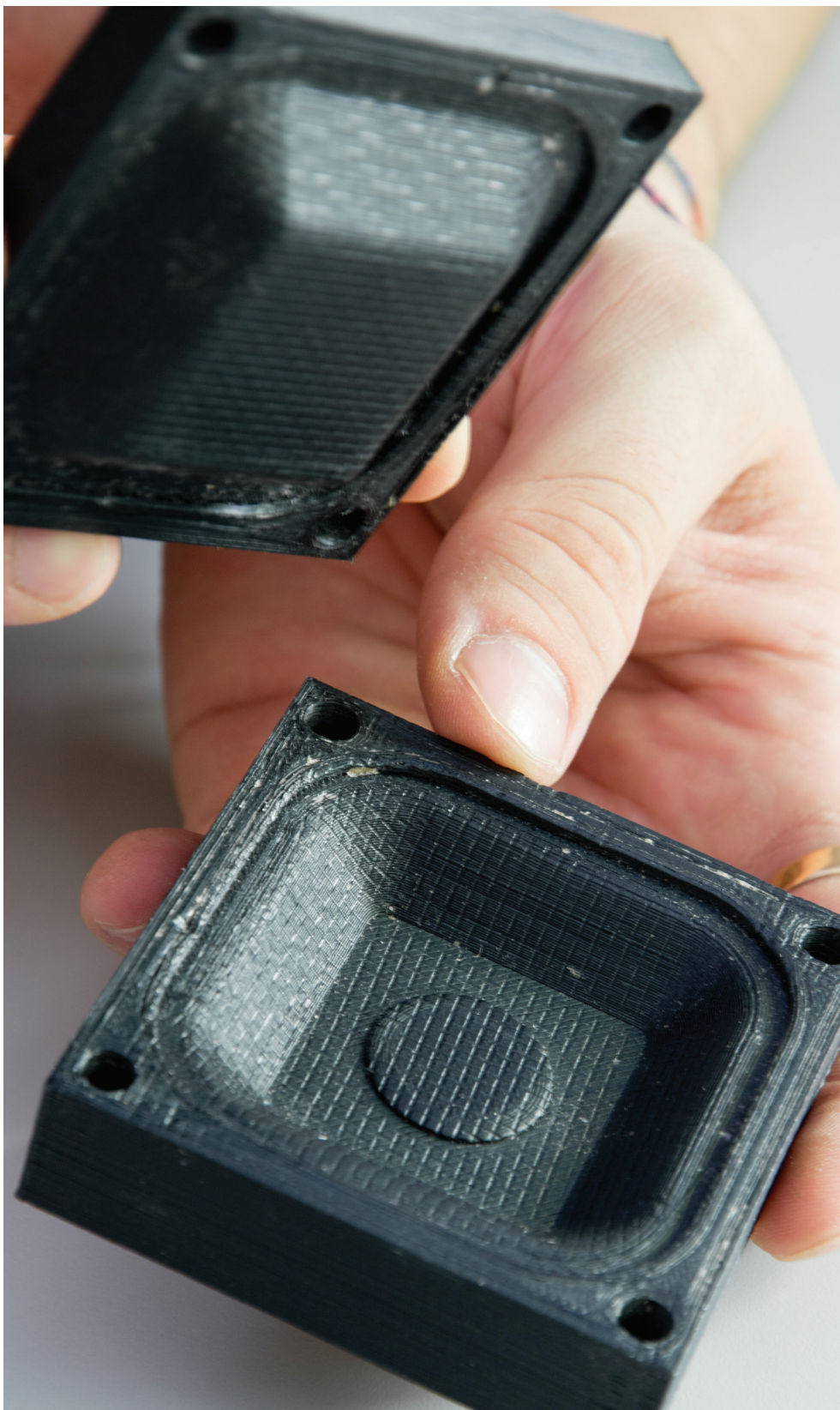
Fig.4.28 Prima coppia di stampo e controstampo realizzata in scala ridotta.
