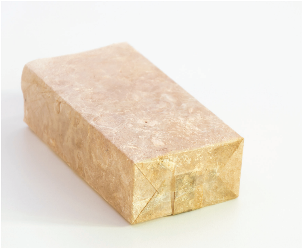
Fig.4.44 Seconda fase di formatura del film in cellulosa microbica.
