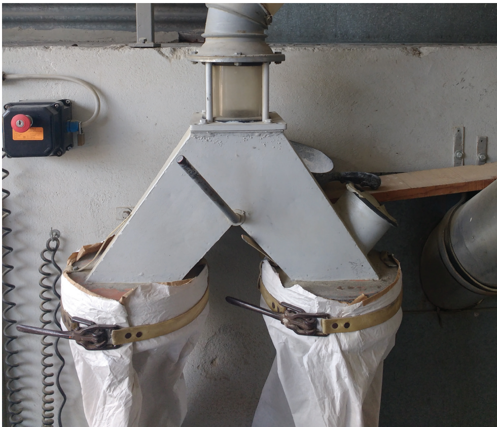
Fig.3.15 Fine corsa dei canali aspiranti per la raccolta dei residui.
