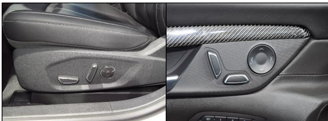
Figura 5.2.3: Esempio di soluzione per comandi supporto lombare elettrici (Fonte: A2Mac1 con modifiche)
