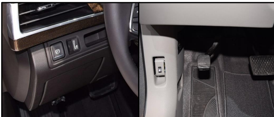
Figura 6.2: Esempio di soluzioni per il freno di stazionamento (Fonte: A2Mac1 con modifiche)
