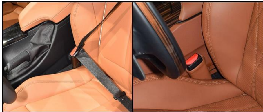
Figura 5.1.11: Esempio di soluzione preferibile per il frustino della cintura di sicurezza (Fonte: A2Mac1 con modifiche)
