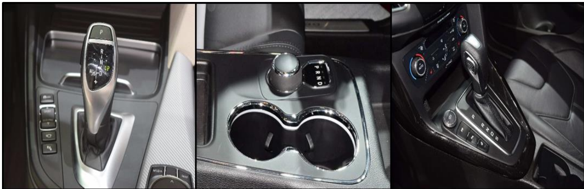
Figura 6.25: Esempi di cambio automatico; da sinistra verso destra: Cambio a posizioni instabili – cambio rotary – cambio a posizioni stabili (Fonte: A2Mac1 con modifiche)
